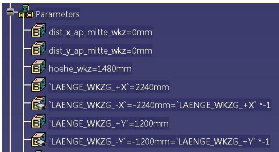
Slika 3.21 Primjer parametarskog seta pomoću kojeg određujemo visine i gabarite alata
