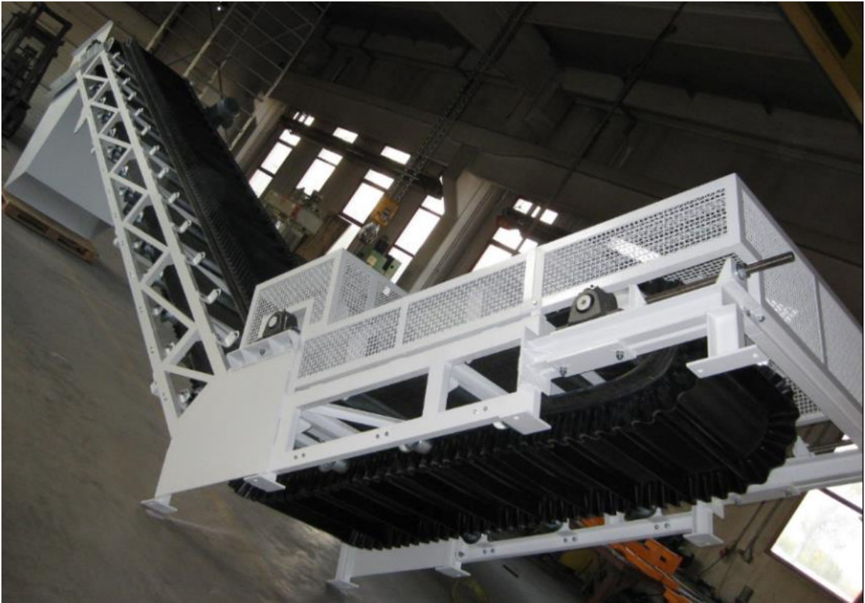
Slika 21. Transporter trakasti proizvodnje Oprema Vrbovec d.o.o.
