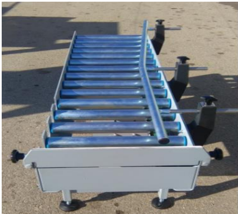
Slika 5. Kotrljača sa zaustavljačem materijala
