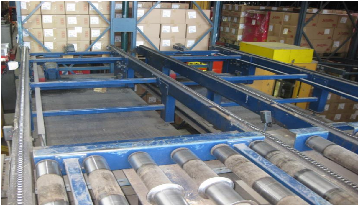
Slika 14. Transport paleta lančanim prijenosom
