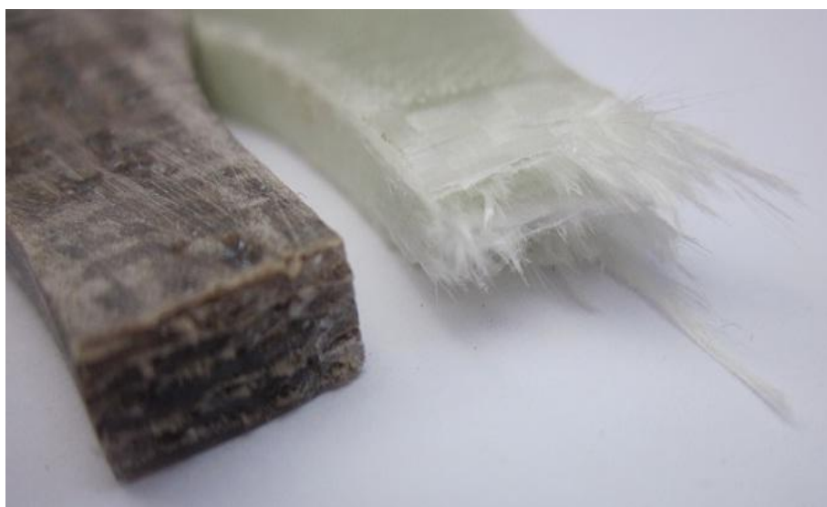
Slika 39. Površine loma za kompozite 1 sa jutenim i staklenim vlaknima
