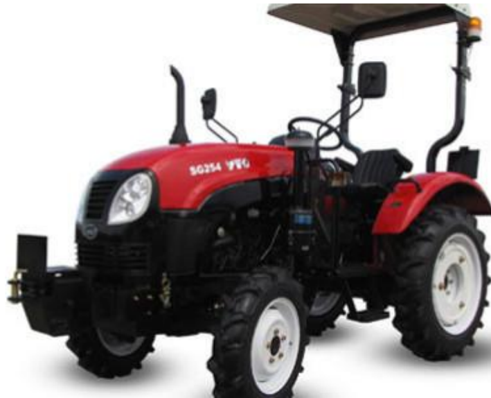
Sl. 8. Traktor sa zaštitnim okvirom [15]
