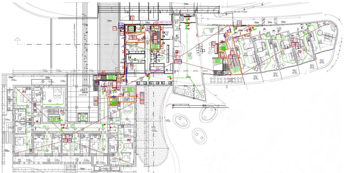
Slika 4. Prikaz požarnih sektora prizemlja hotela Alhambra [8]
