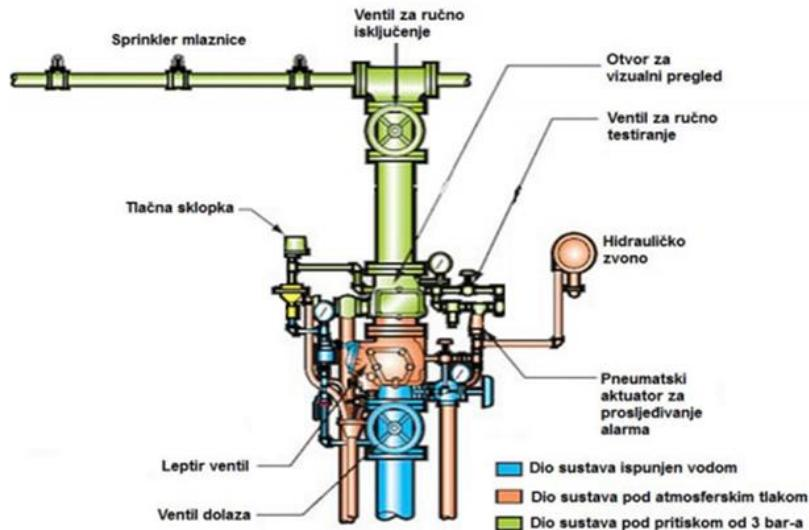
Slika 26. Predodžba dijela suhog sprinkler sustava [22]
