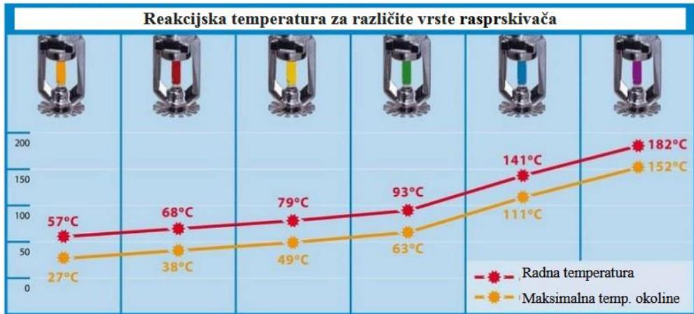
Slika 36. Sprinkler mlaznice sa staklenom ampulom [24]
