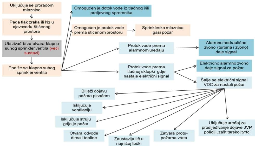
Slika 25. Shematski prikaz rada suhog sprinkler sustava [14]
