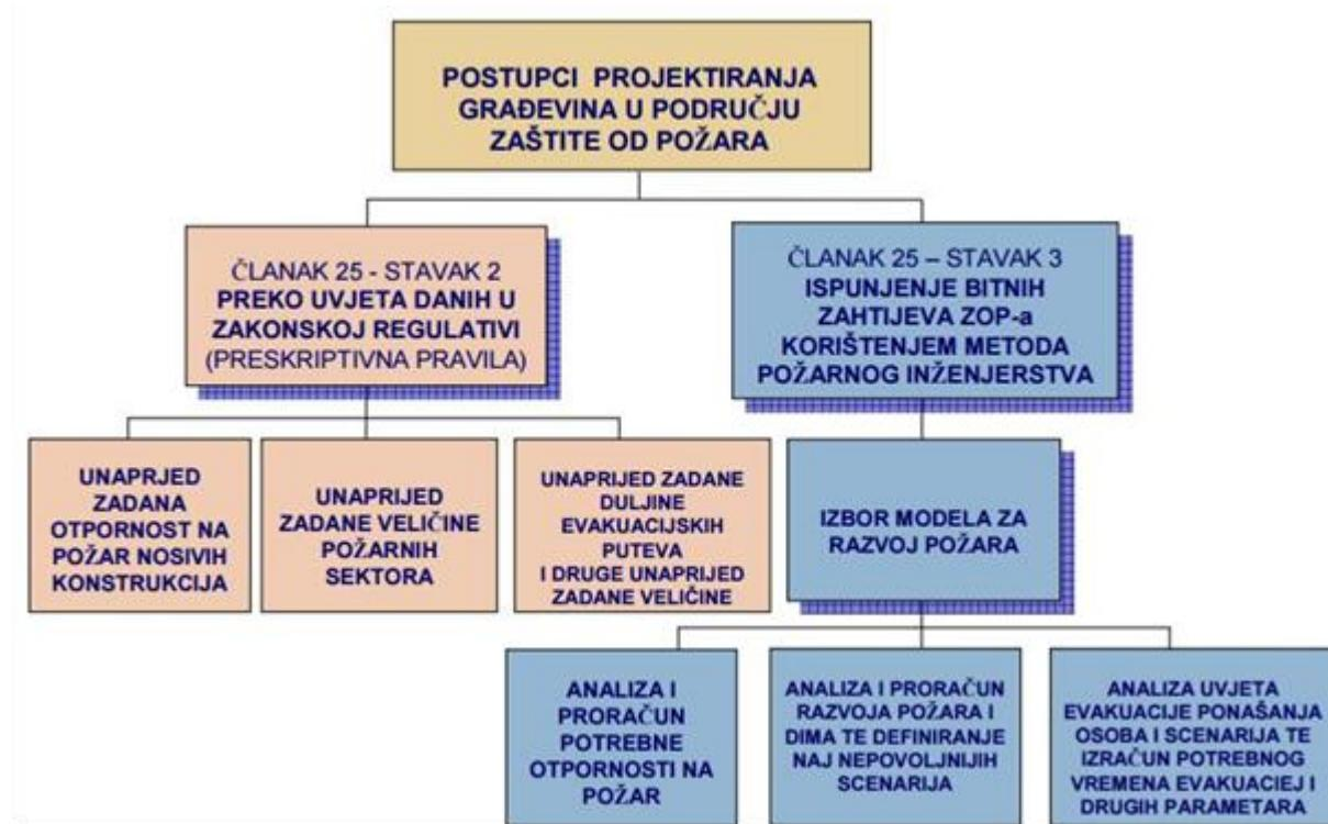
Slika 2. Osnovni pristupi pri izradi protupožarnog elaborata [2]
