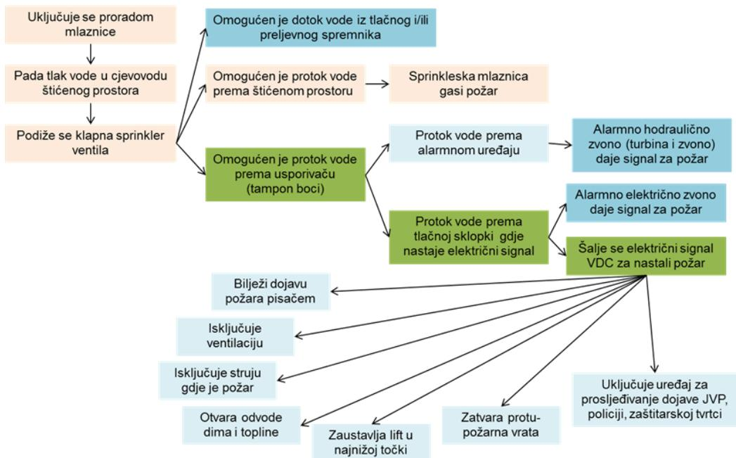
Slika 24. Shematski prikaz rada mokrog sprinkler sustava [14]
