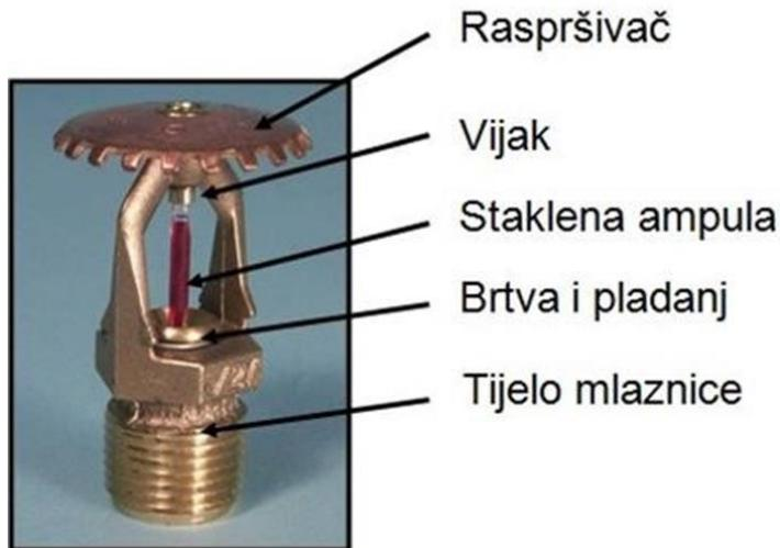
Slika 37. Osnovni dijelovi sprinkler mlaznice [24]
