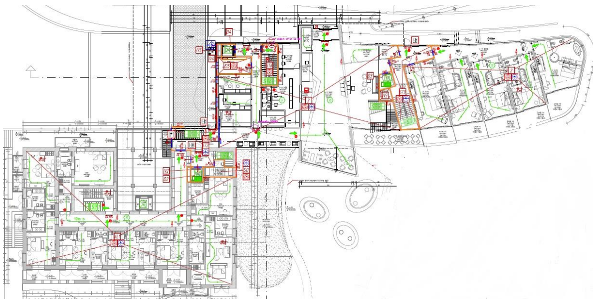
Slika 4. Prikaz požarnih sektora prizemlja hotela Alhambra [8]
