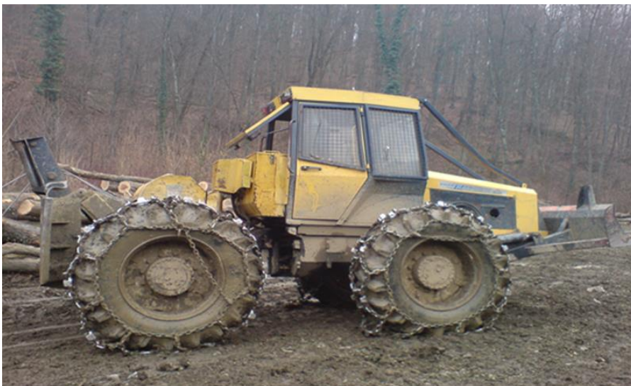
Slika 8. Šumski zglobni traktor (skider)
