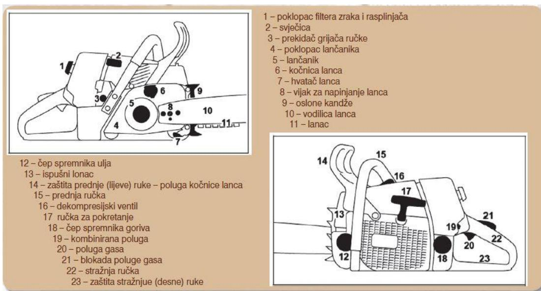
Slika 7. Prikaz dijelova motorne pile
