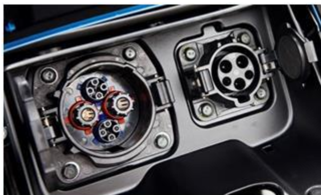
Slika 39. CHAdeMO (lijevo) i J1772 (desno) utičnica na Leafu
