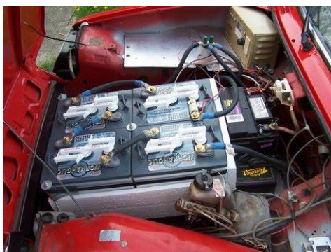
Slika 17. Olovna baterija za elektroauto
