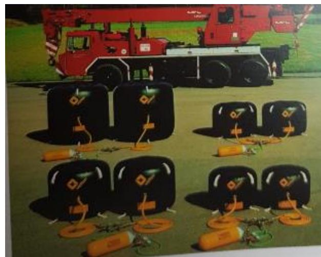
Slika 13. Niskotlačni zračni jastuci [1]
