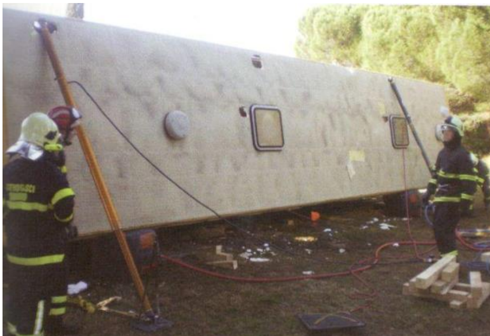
Slika 33. Podizanje autobusa pomoću zračnih jastuka [1]
