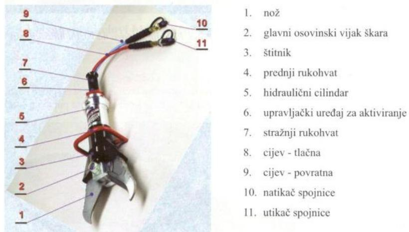
Slika 9. Hidraulične škare [1]
