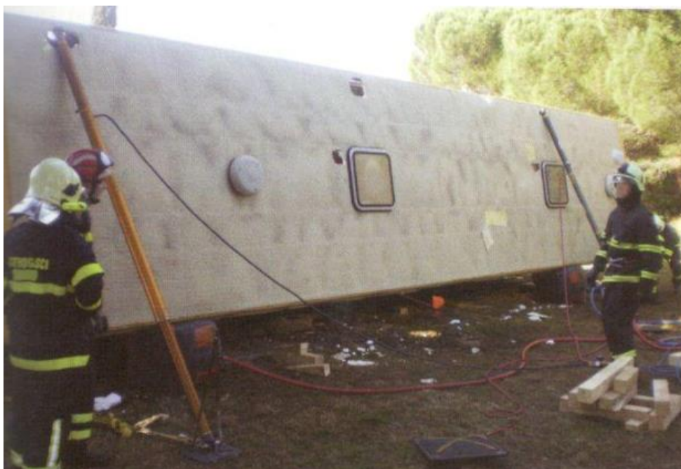
Slika 33. Podizanje autobusa pomoću zračnih jastuka [1]
