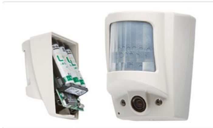
Slika 19. Predodžba kamere sa ugrađenim detektorom pokreta.[12]
