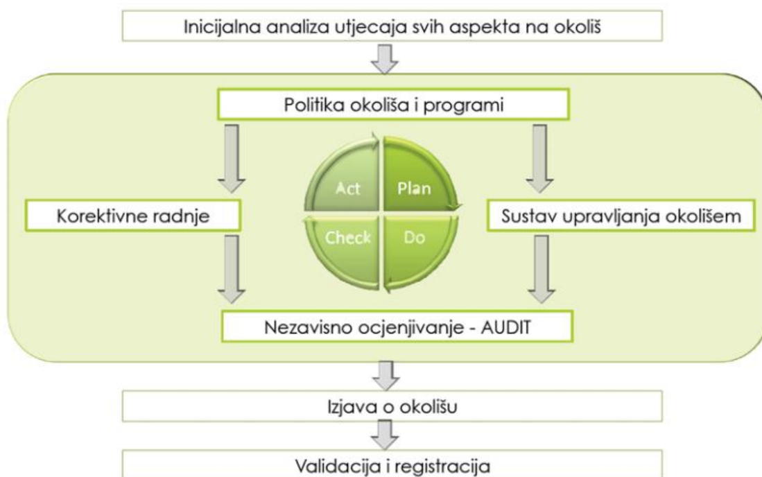
Slika 5. Shema implementacije i provođenja EMAS sustava [5]
