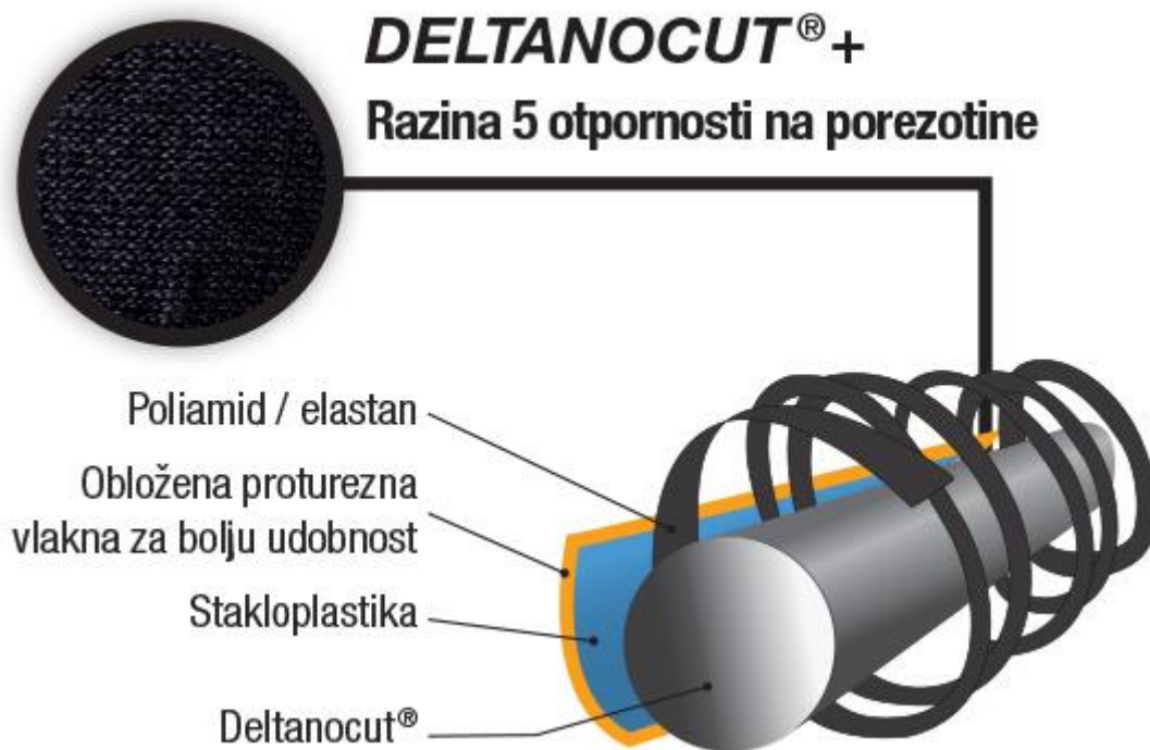
Slika 22. Vlakna za izradu rukavica otpornosti 5 [28]
