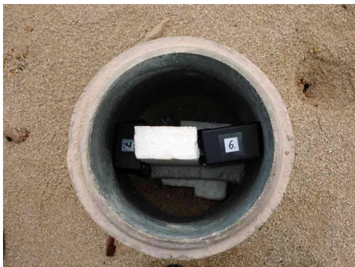
Slika br. 5 IC senzor smješten u zaštitnoj betonskoj cijevi
