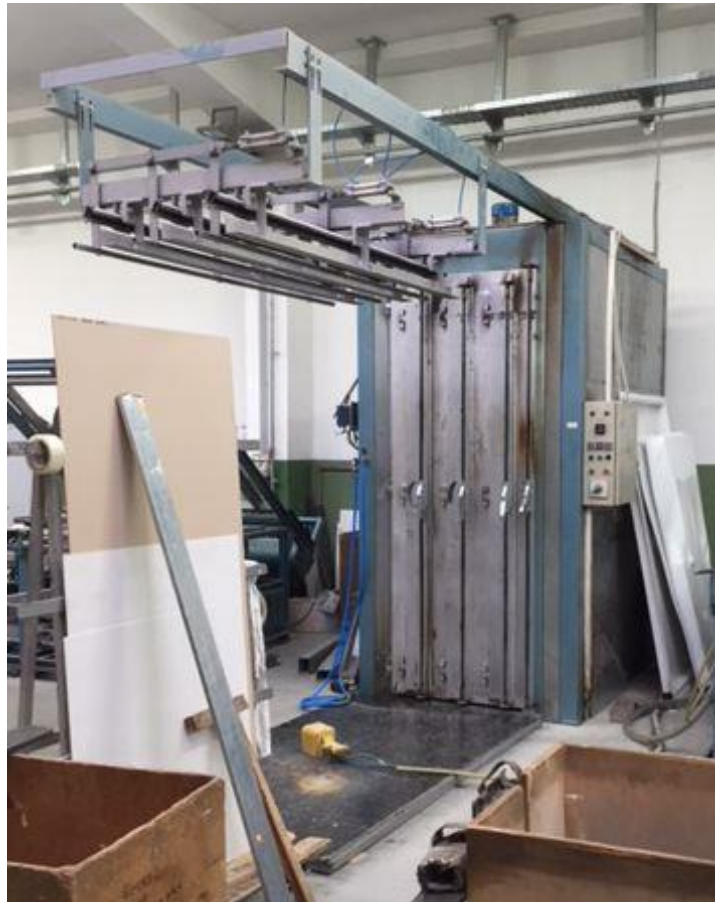
Slika 12: Vertikalna peć s 3 staze za zagrijavanje ploča
