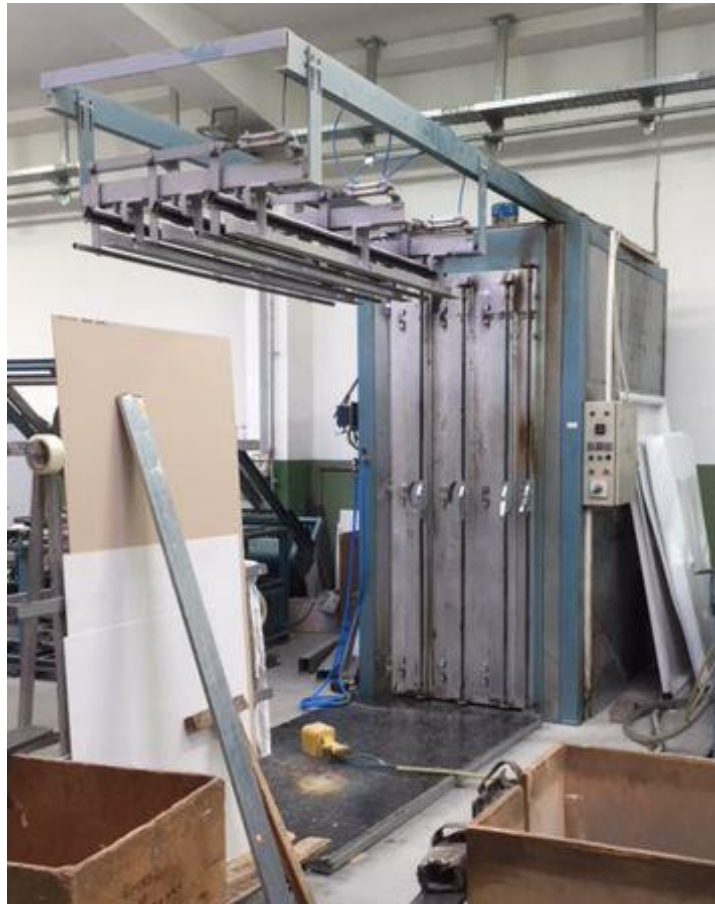
Slika 12: Vertikalna peć s 3 staze za zagrijavanje ploča
