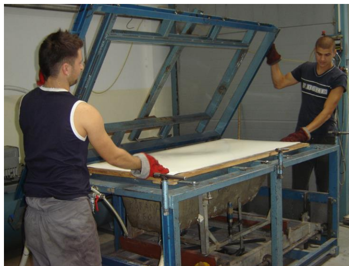
Slika 13: Stavljanje zagrijane ploče akrila na napravu za oblikovanje vakuumom
