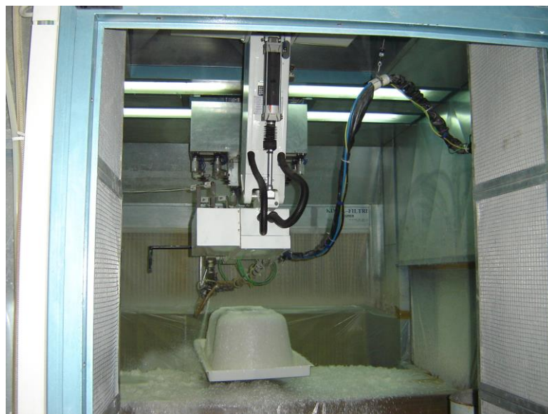
Slika 16: Kabina za automatsko nanošenje smjese za ojačanje
