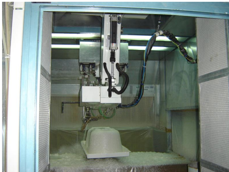
Slika 16: Kabina za automatsko nanošenje smjese za ojačanje
