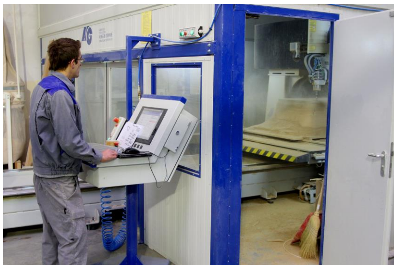
Slika 9: Obrada modela za kalup na 5-osnom CNC stroju
