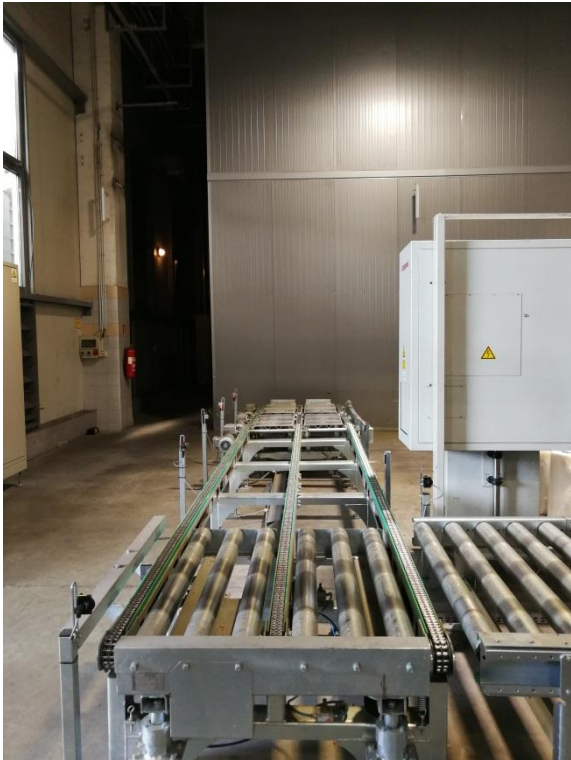
Slika 16. Transportna traka za preuzimanje paleta
