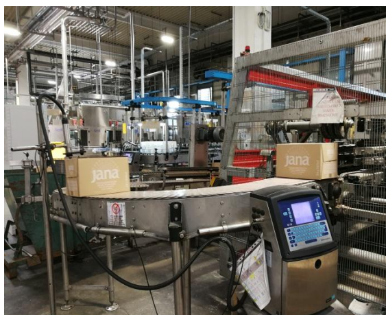
Slika 13. Transportna traka od upakivača prema paletizatoru
