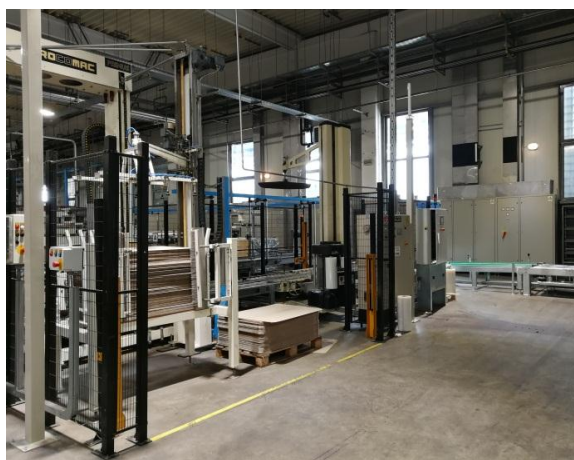
Slika 15. Paletizator i prostor za omotavanje paleta
