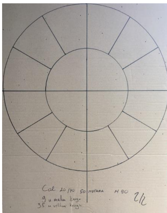
Slika 26: Meta pogođena na 50 metara metkom Sellier & Bellot kalibra 20/70
