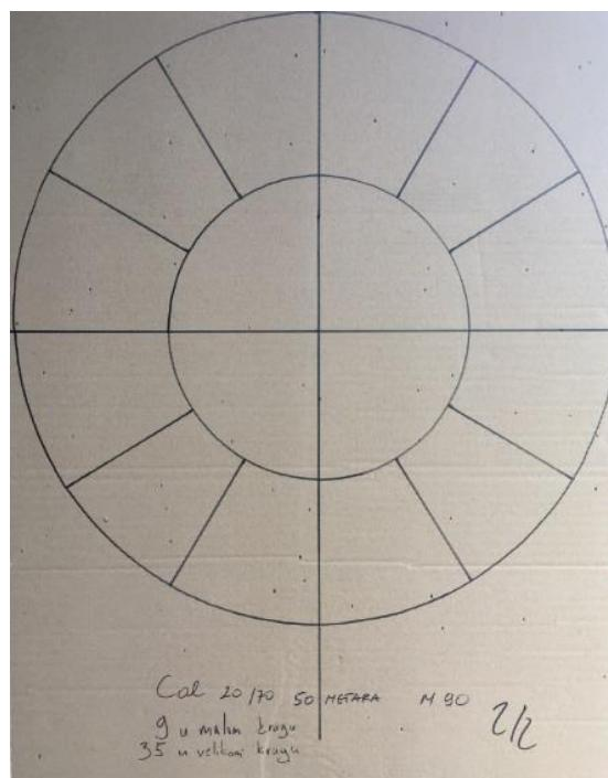
Slika 27: Meta pogođena na 50 metara metkom M-90 kalibra 20/70
