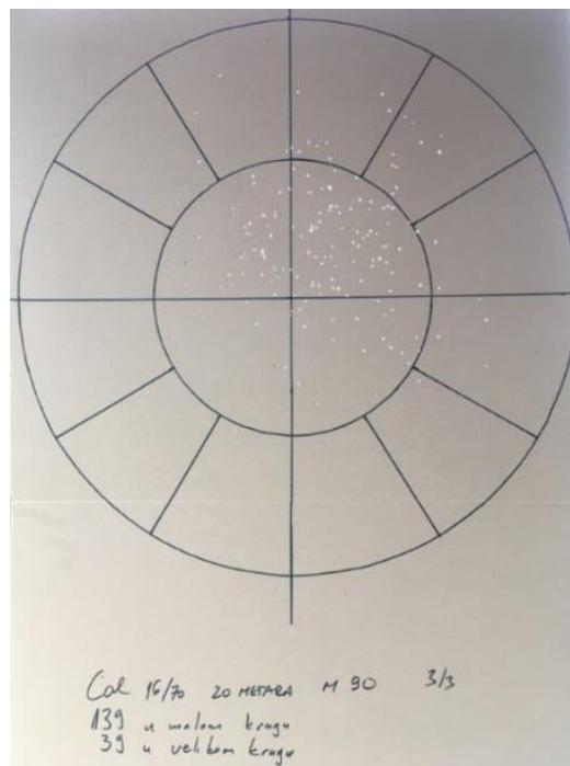
Slika 12: Meta pogođena na 20 metara metkom M-90 kalibra 16/70
