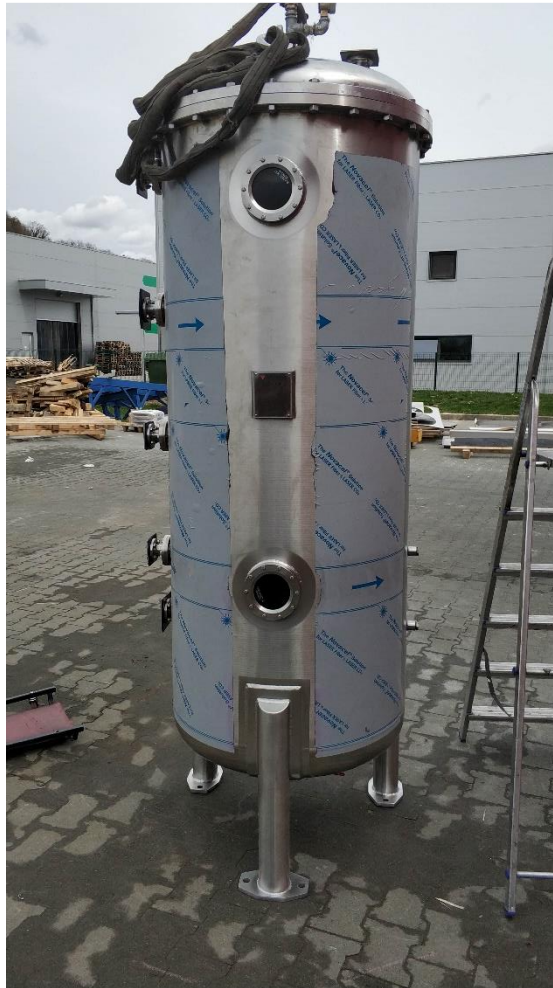
Slika 37. Priprema spremnika za tlačnu probu
