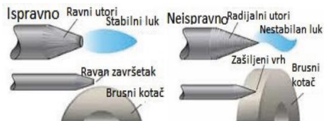
Slika 7. Pravilno i nepravilno brušenje elektrode [5]
