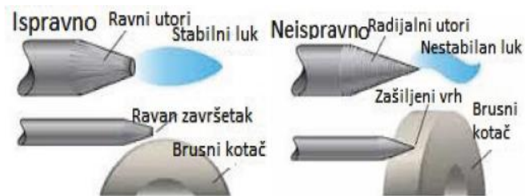
Slika 7. Pravilno i nepravilno brušenje elektrode [5]
