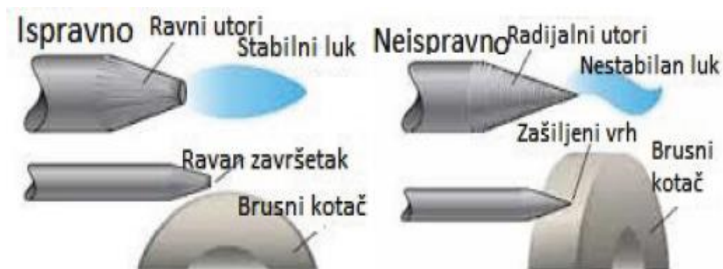
Slika 7. Pravilno i nepravilno brušenje elektrode [5]
