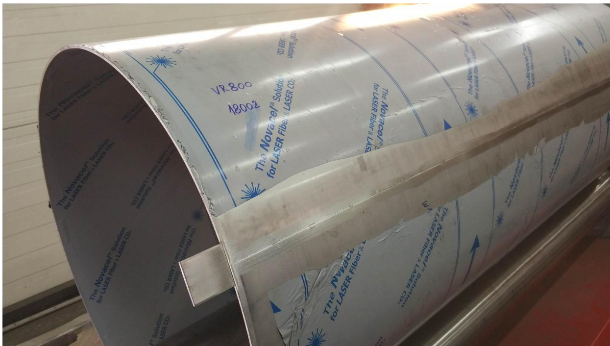
Slika 28. Priprema plašta za izradu uzdužnog zavora
