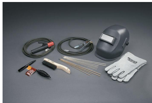
Slika 28. Oprema za zavarivanje
