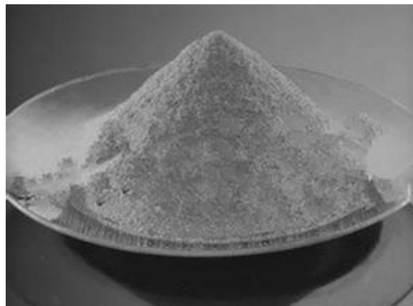
Slika 9. Atomizirani aluminijski prah [15]
