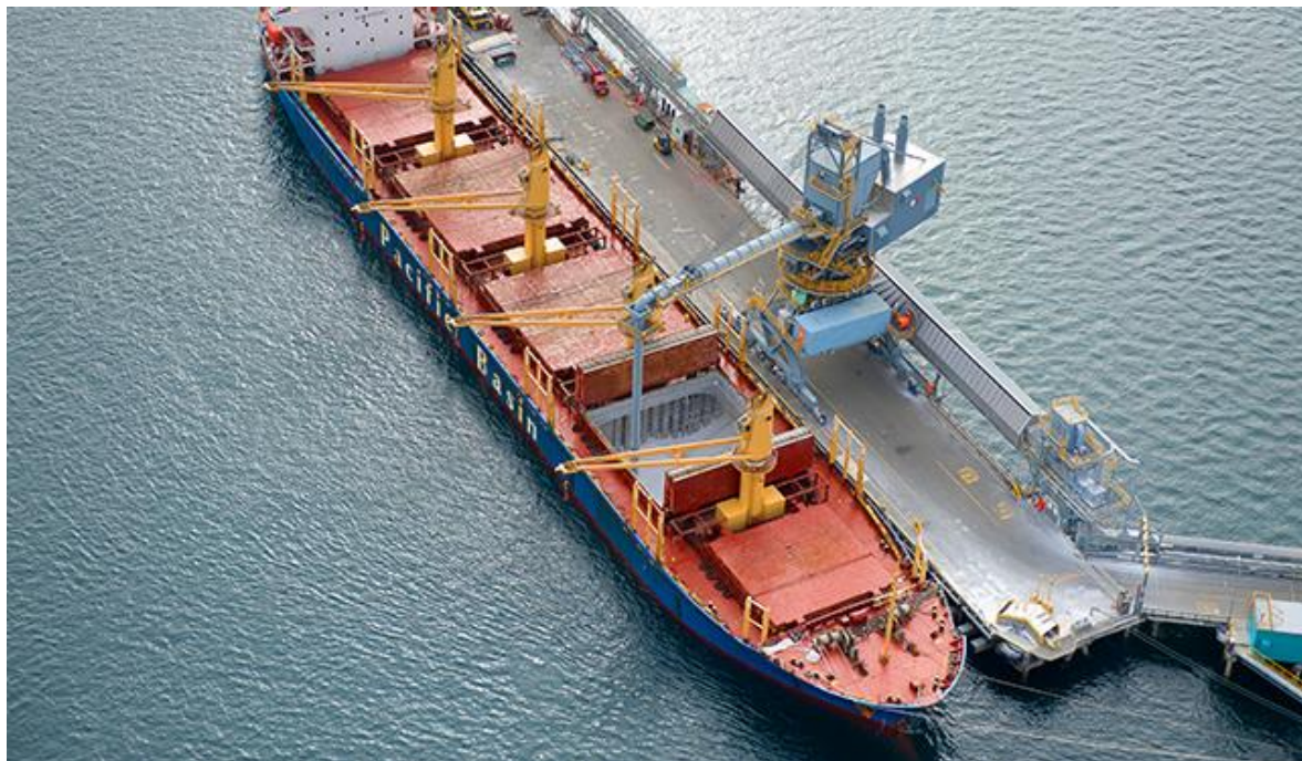
Slika 6. Distribucijski cjevovod za brodski utovar [8]
