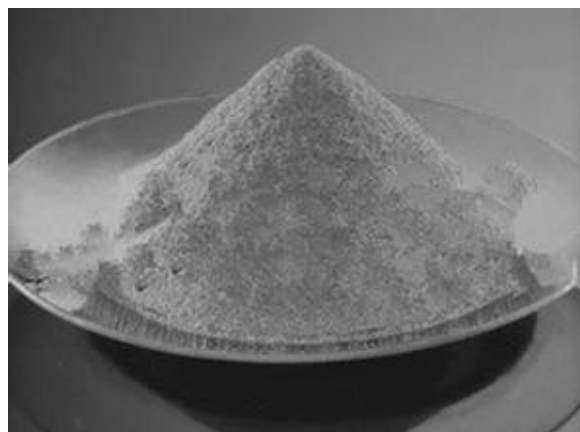
Slika 9. Atomizirani aluminijski prah [15]
