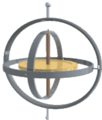
Slika 2: Prstenovi u neutralnom položaju [2]
