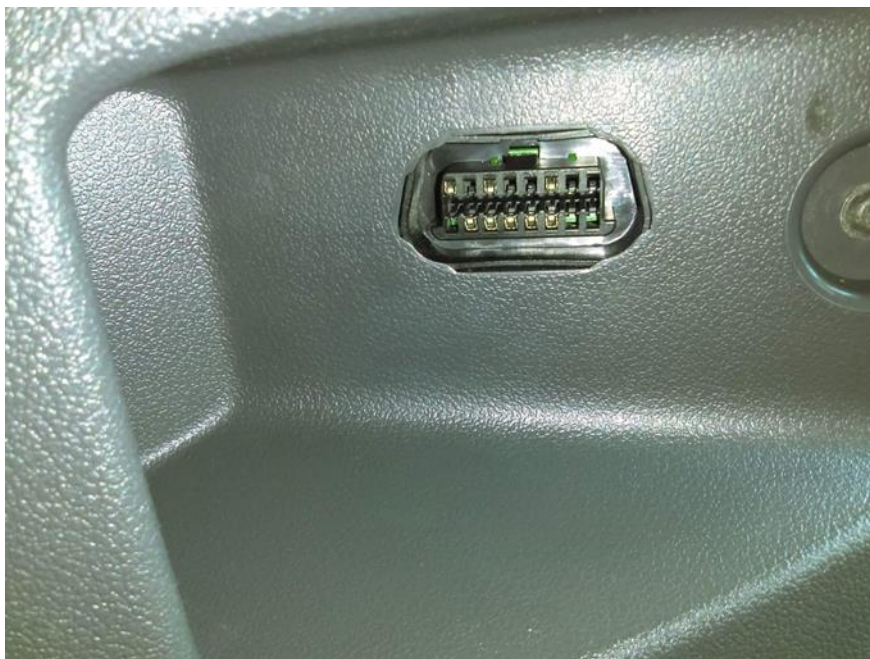
Slika 18. Lokacija OBD-II priključka
