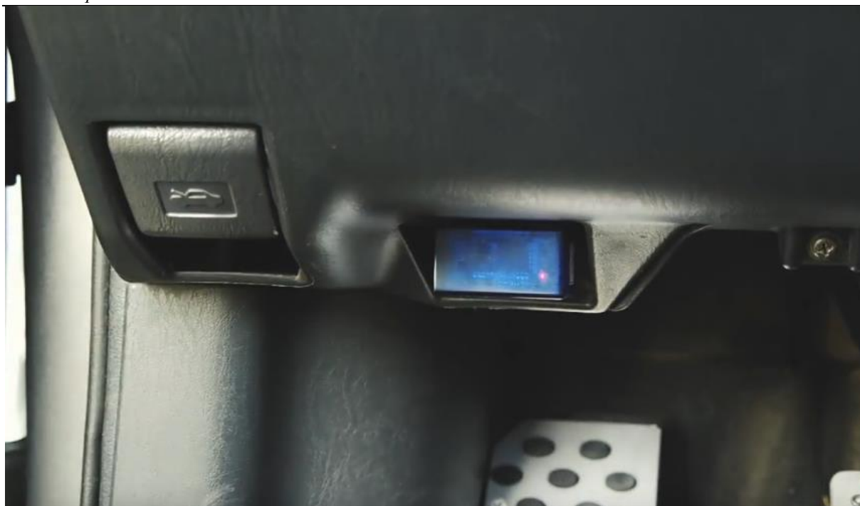
Slika 15. ELM327 dijagnostika s „bluetooth“ modulom
