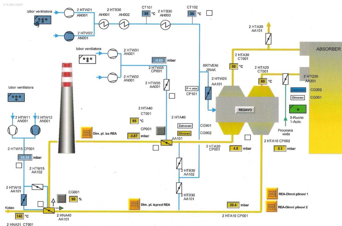
Slika 25. Procesna shema dimnih plinova REA postrojenja.
