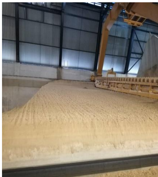
Slika 31. Nagomilavanje gipsa strugalom.
