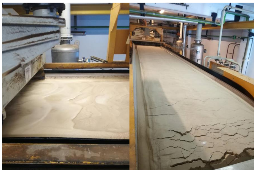
Slika 29. Pojasni filter na ulazu iz hidrociklona i pojasni filter na izlazu.
