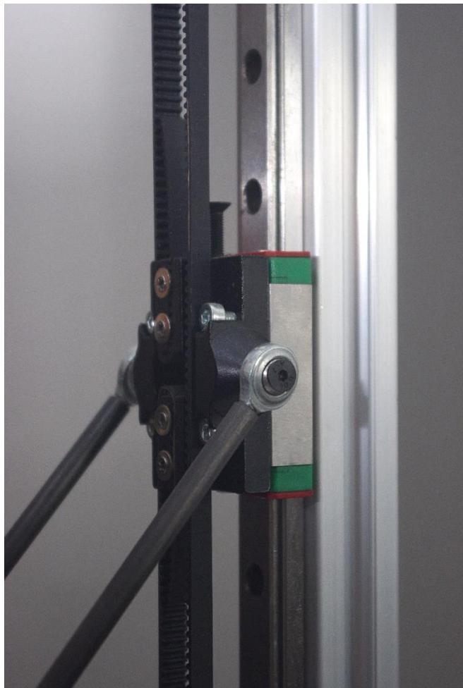
Vodilice ruku se pomiču zupčastim remenjem pomoću koračnih motora. Koračni motori na osovina ima remenice sa 16 zubaca. Remenje je postavljeno oko remenica koračnih motora, sve do remenica na vrhu printera, a spojeno je na vodilici ruke, te ju tako pomiče gore i dolje.
