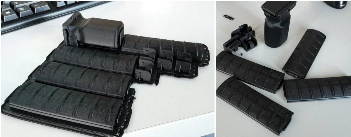
Slika 17. Isprintani predmeti prije i nakon završne obrade. Izvor: Rad autora
