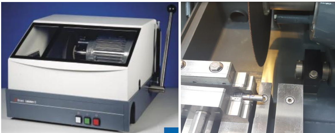
Slika 34: Rezanje epruvete na rezačici Labotom-3
