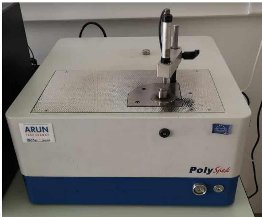
Slika 24: Uređaj za analizu kemijskog sastava materijala
