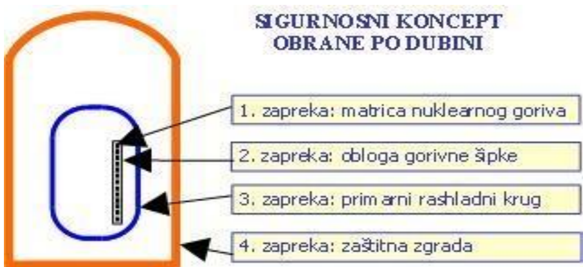
Slika 6. Obrambeni sustav nuklearne elektrane od radioaktivnog zračenja
