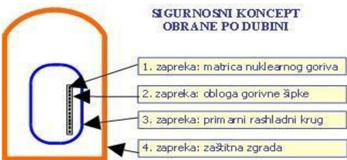
Slika 6. Obrambeni sustav nuklearne elektrane od radioaktivnog zračenja
