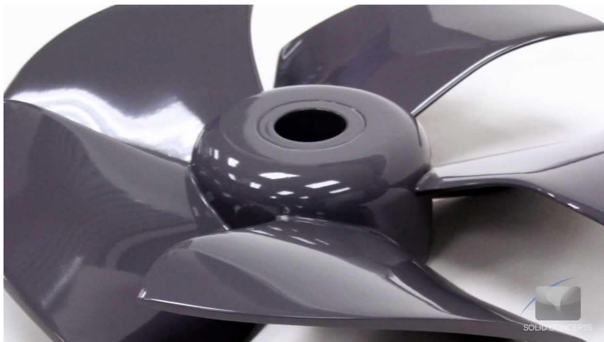
Slika 3.6. Proizvod izrađen FDM postupkom [7]
