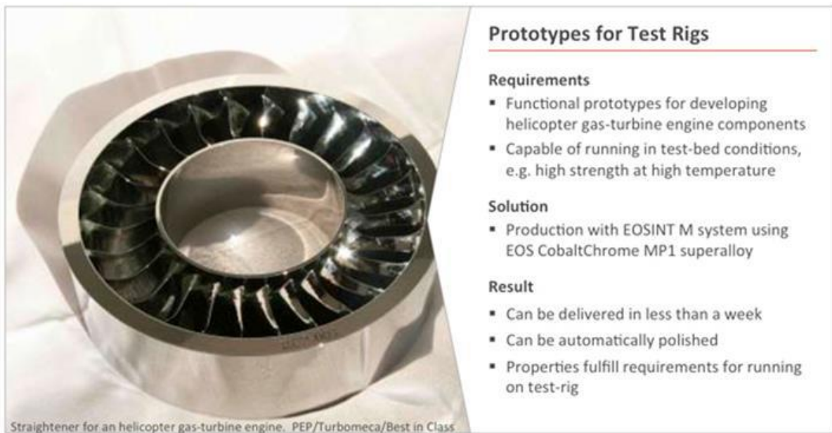
Slika 4.5. Turbina izrađena primjenom aditivne proizvodnje [14]
