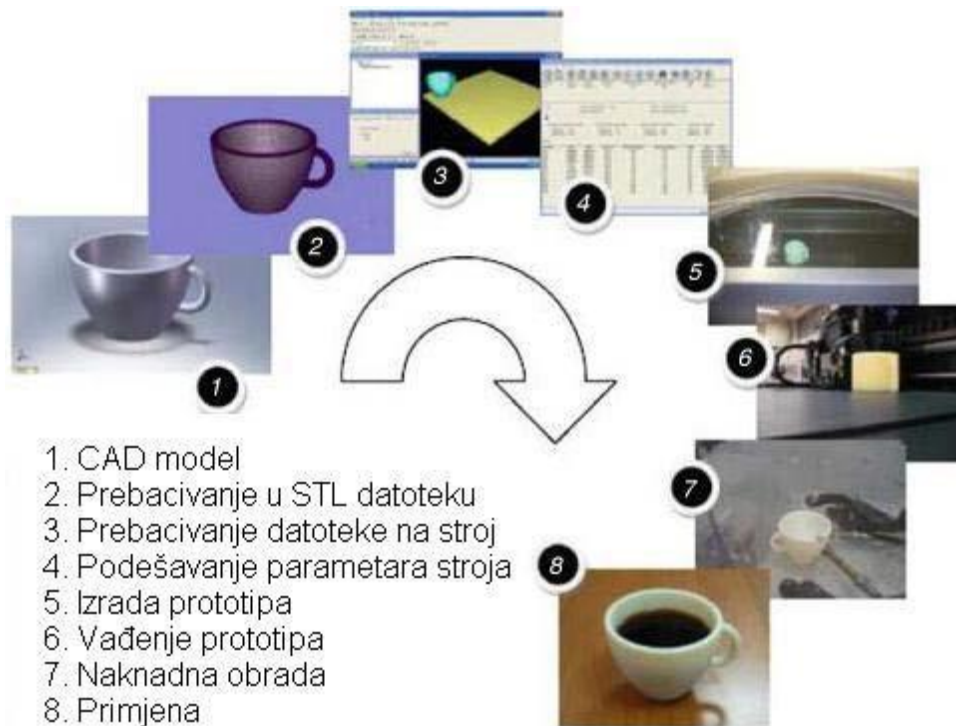
Slika 2.2.Faze brze proizvodnje prototipa [2]
