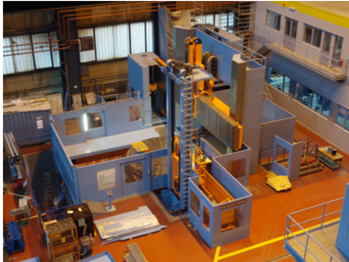
Slika 1.1 Obradni centar Waldrich Coburg Multi Turn 5500 AM
