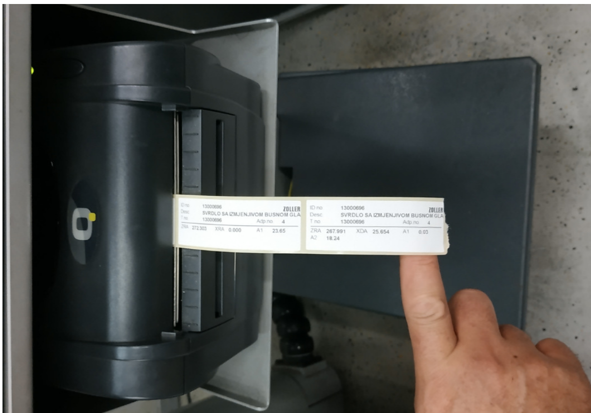
Slika 4.15 Etikete s izmjerama dužine i promjera alata
