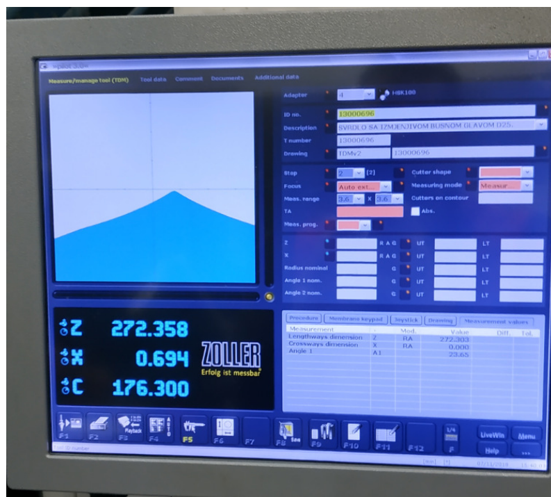
Slika 4.14 Mjerenje dužine alata na vrhu svrdla
