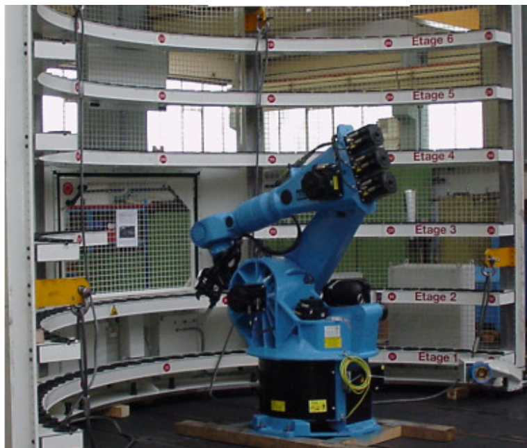
Slika 4.23 Robotska ruka s dvostrukim hvatačem alata
