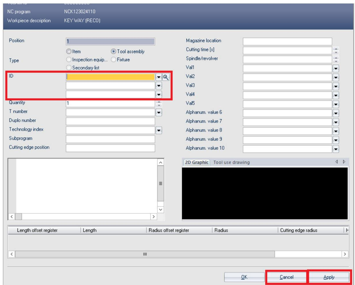
Slika 2.24 Unos sklopova alata u listu alata
