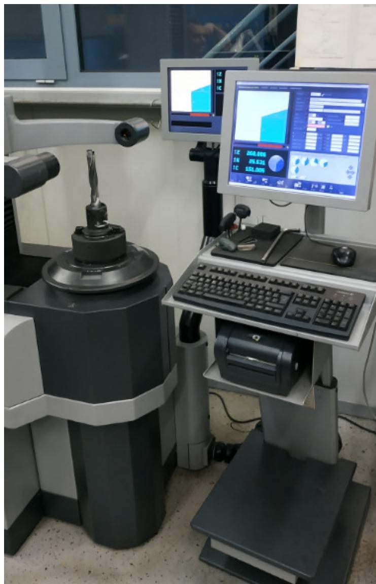
Slika 4.12 Mjerenje alata na uređaju za prednamještanje alata
