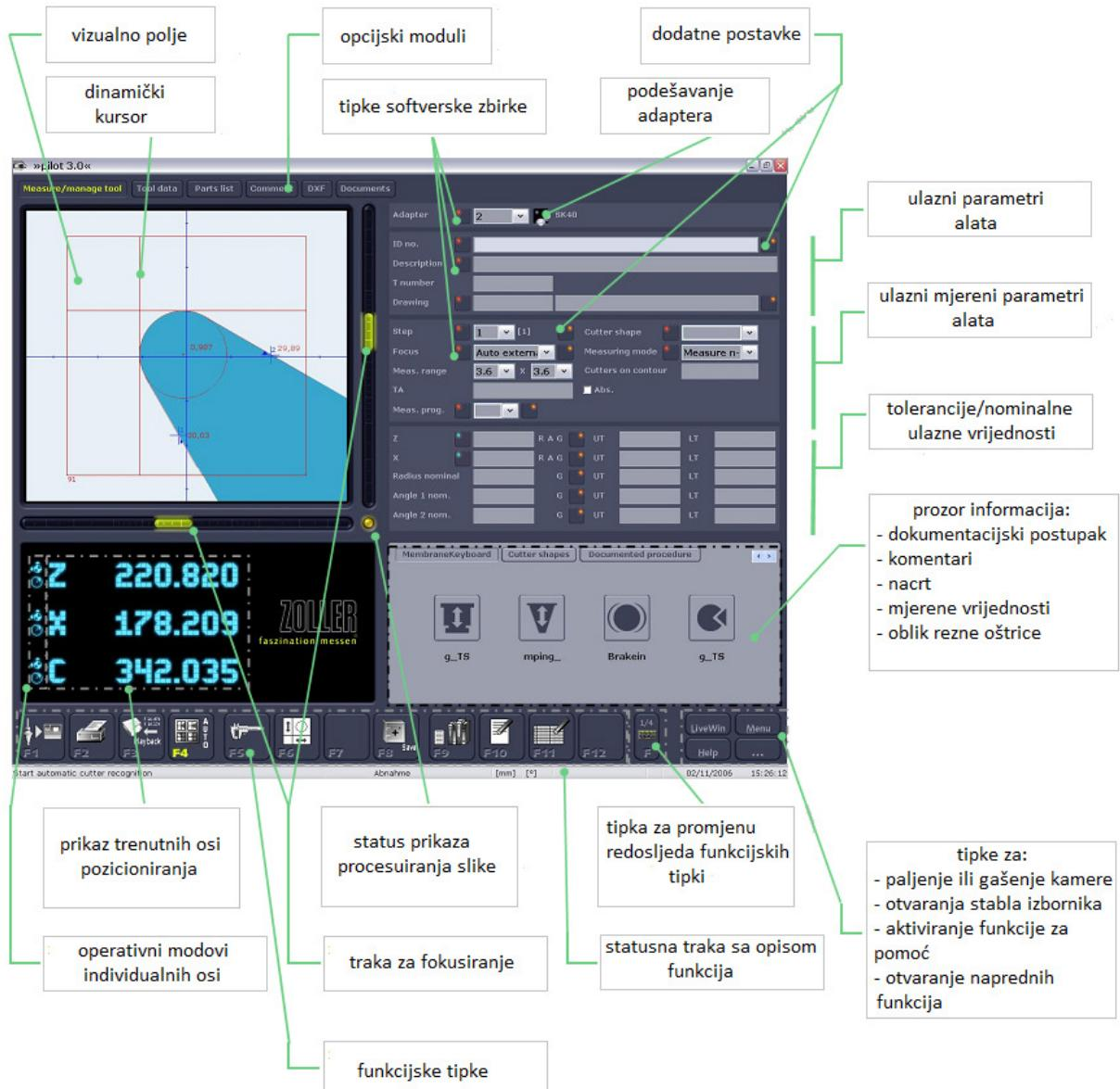
Slika 4.5 Strukturalni i operacijski koncept prikaza mjerena alata
