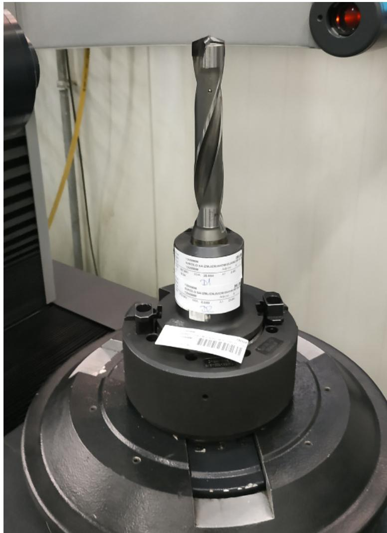
Slika 4.18 Etiketirani alat s izmjerama te jedinstvenim brojevnim nazivom i bar-kodom
