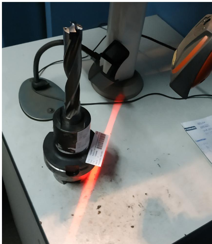
Slika 4.19 Očitavanje jedinstvenog brojevnog naziva pomoću bar-kod čitača
