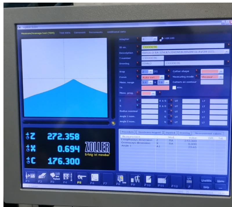
Slika 4.14 Mjerenje dužine alata na vrhu svrdla
