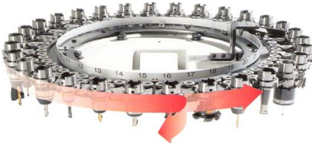
Slika 4.6 Diskovno spremište alata
