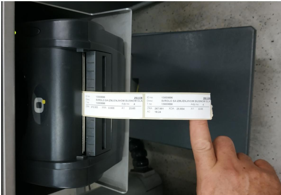
Slika 4.15 Etikete s izmjerama dužine i promjera alata
