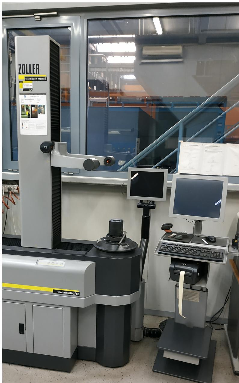
Slika 4.4 Zoller venturion 800/12 uređaj za prednamještanje alata
