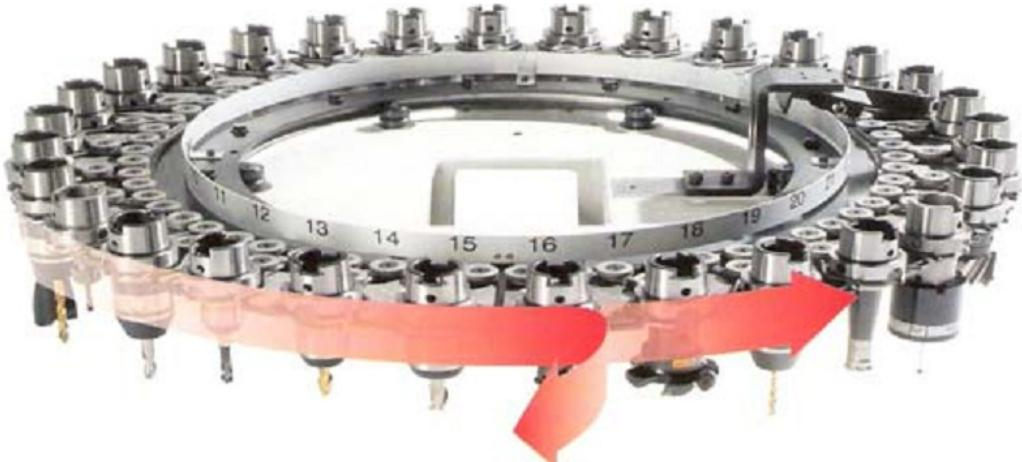
Slika 4.6 Diskovno spremište alata
