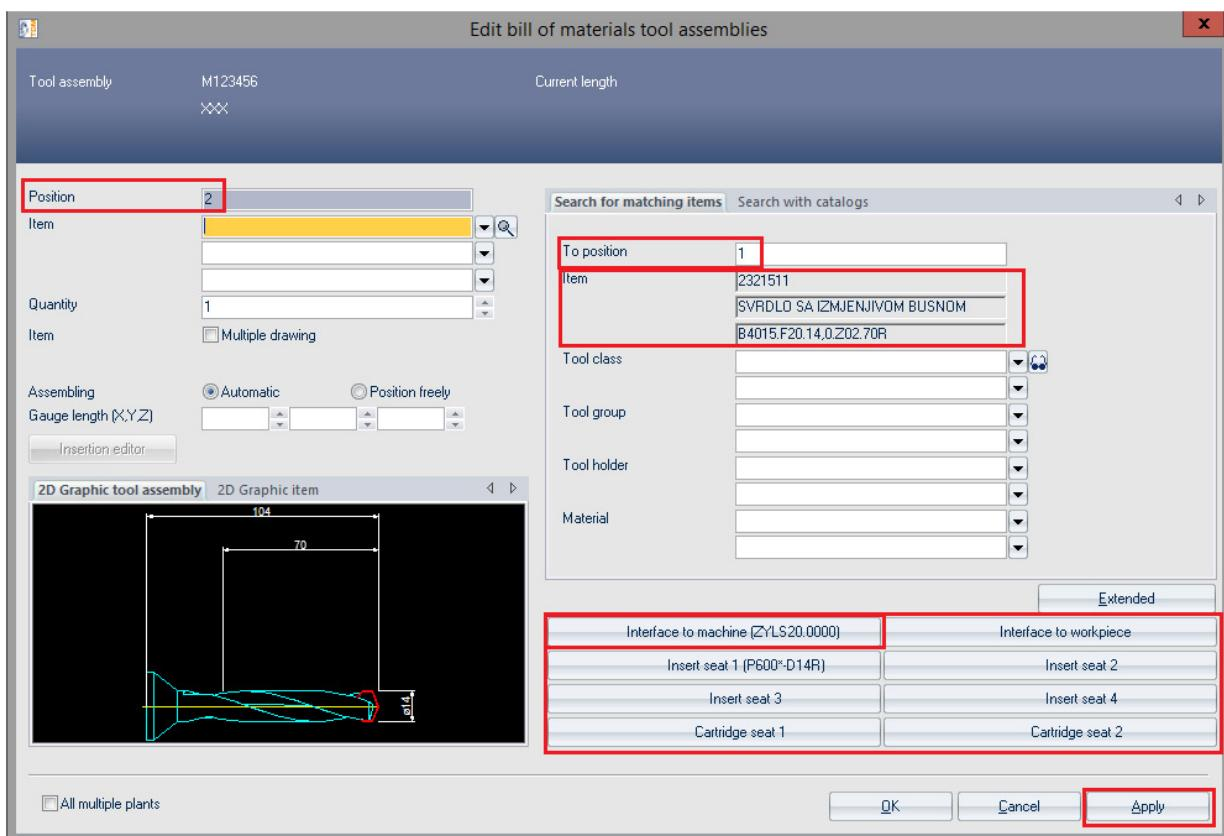
Slika 2.17 Srvdlo s izmjenjivom bušnom glavom kao vodeća komponenta sklopa
