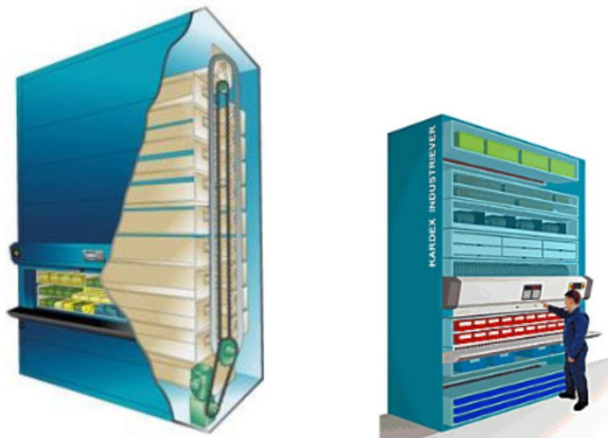
Slika 2.3 Vertikalni karusel
