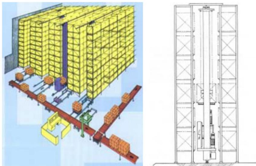
Slika 2.4 Klasično automatizirani visokoregalni „unit-load AS/RS“ sustav
