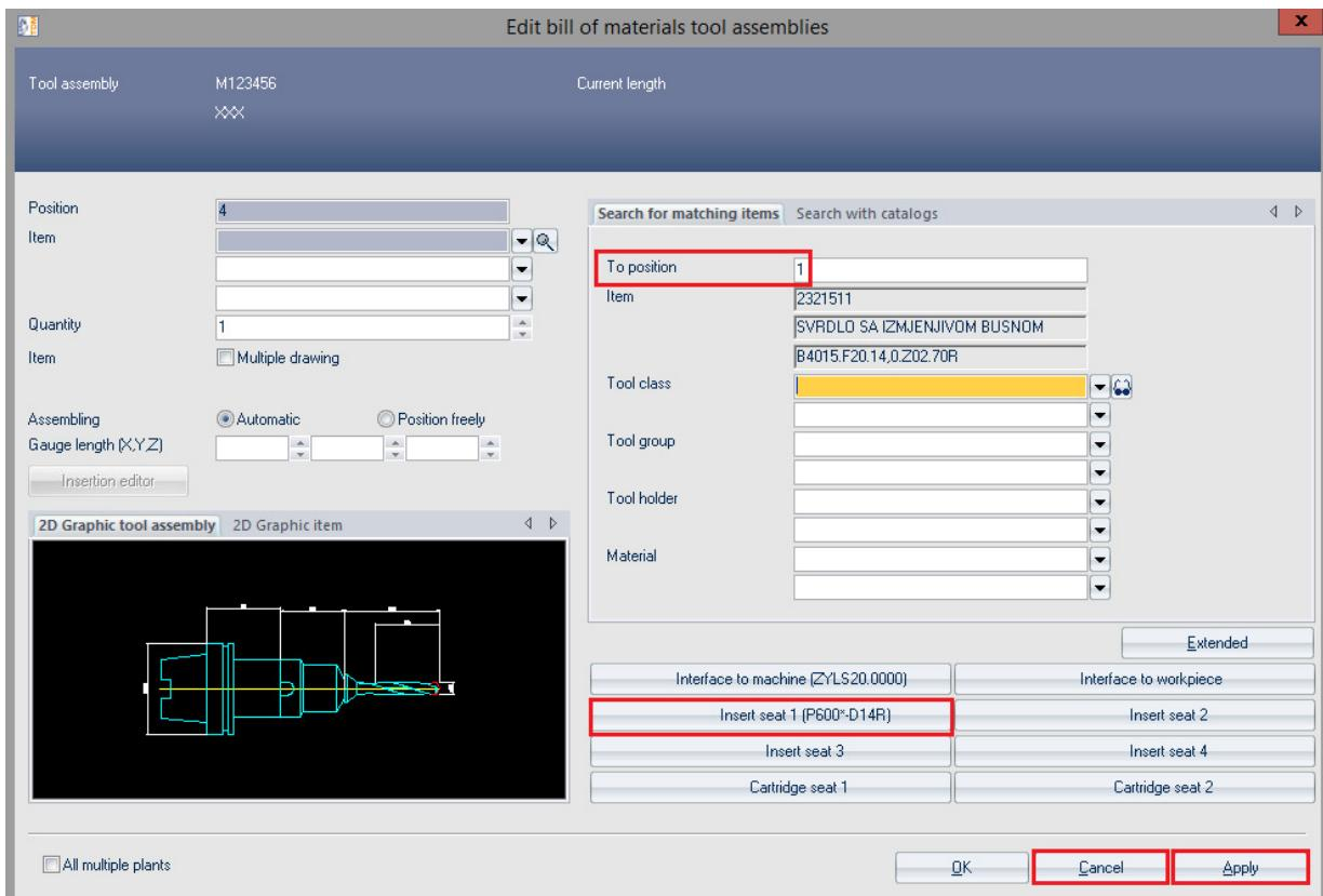
Slika 2.19 Kompletan sklop alata s odabirom rezne pločice
