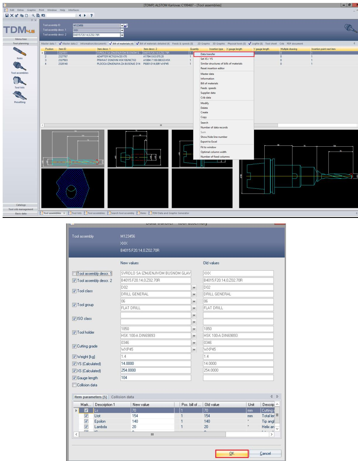
Slika 2.20 Završno kreirani sklop alata s „Data transfer“ prozorom
