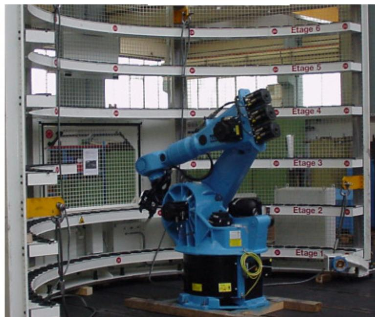
Slika 4.23 Robotska ruka s dvostrukim hvatačem alata
