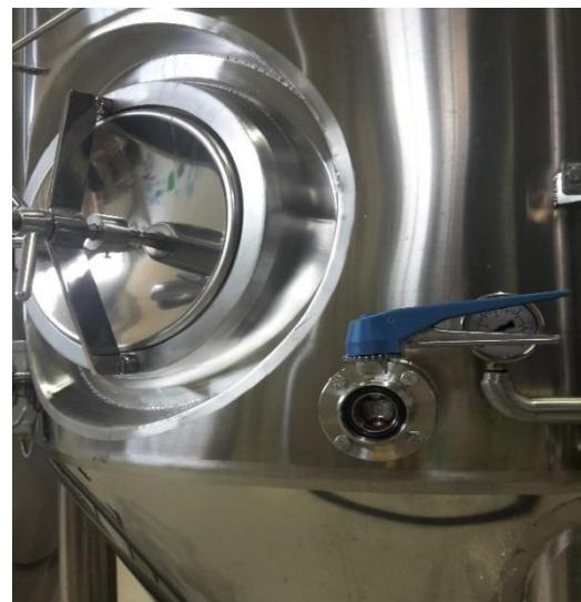
**Slika 12.** Ventil za uzimanje uzorka, pigtail
