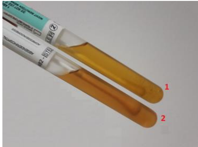
Slika 14. Prikaz uzorka 1-pozitivan rezultat, 2-negativan rezultat
