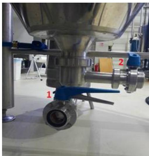
**Slika 13.** 1-ventil za potpuni ispust, 2-ventil za nepotpuni ispust
