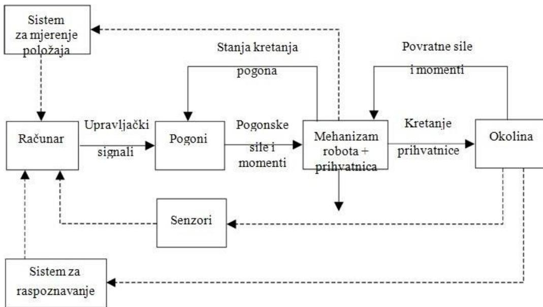
Slika 17. Funkcionalna shema industrijskog robota
