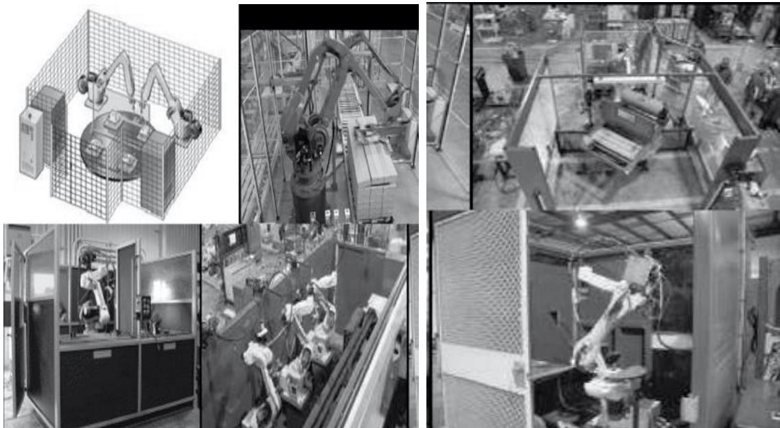
Slika 25. Mehanička zaštita radnog prostora industrijskog robota
