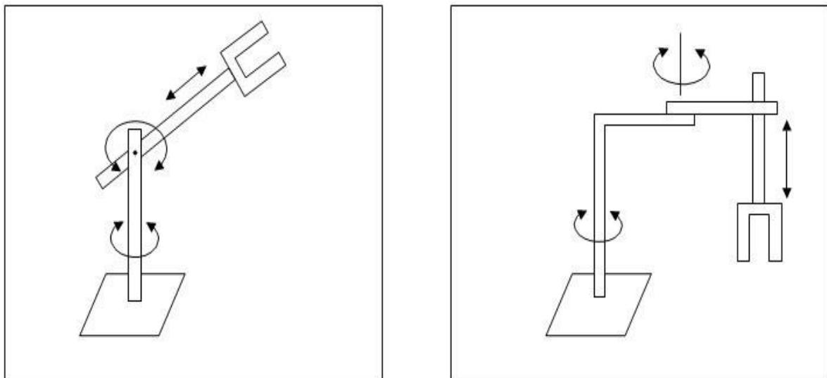
Slika 7. Primjer robota sferne konfiguracije
