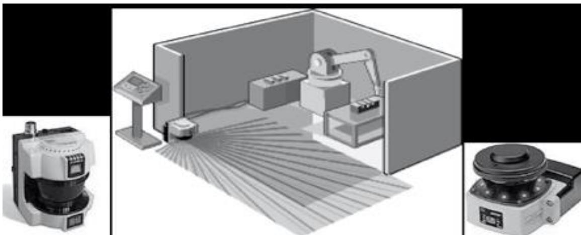
Slika 20. Uredaj za zaštitu radnog prostora robota s uređajem za skeniranje površine
