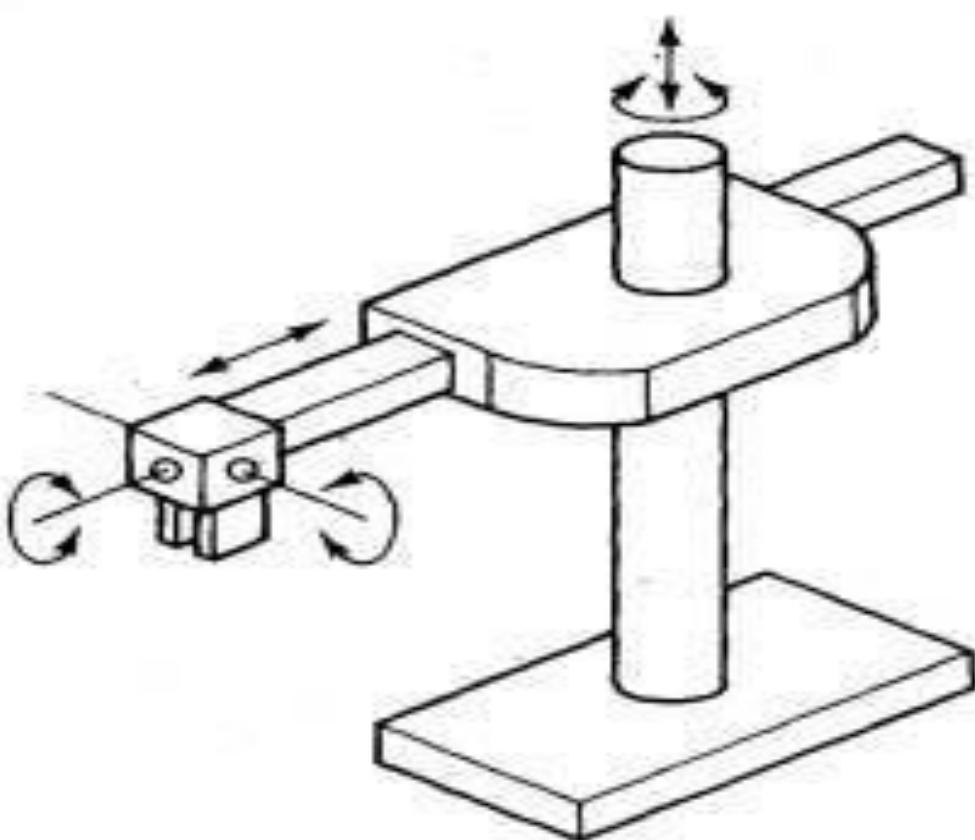
Slika 6. Cilindrična konfiguracija robota
