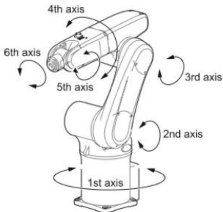
Slika 11. Prikaz osi robota
