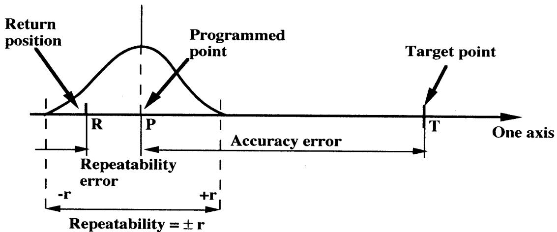
Slika 14. Ponovljivost robota
