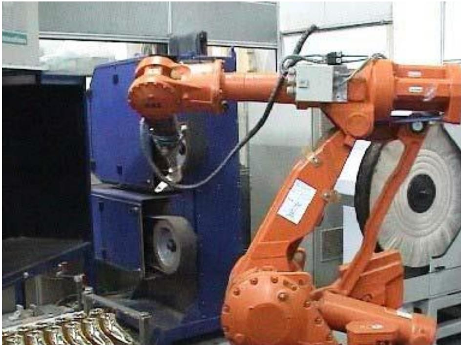
Slika 18. Primjena robota kod tračnog brušenja i poliranja
