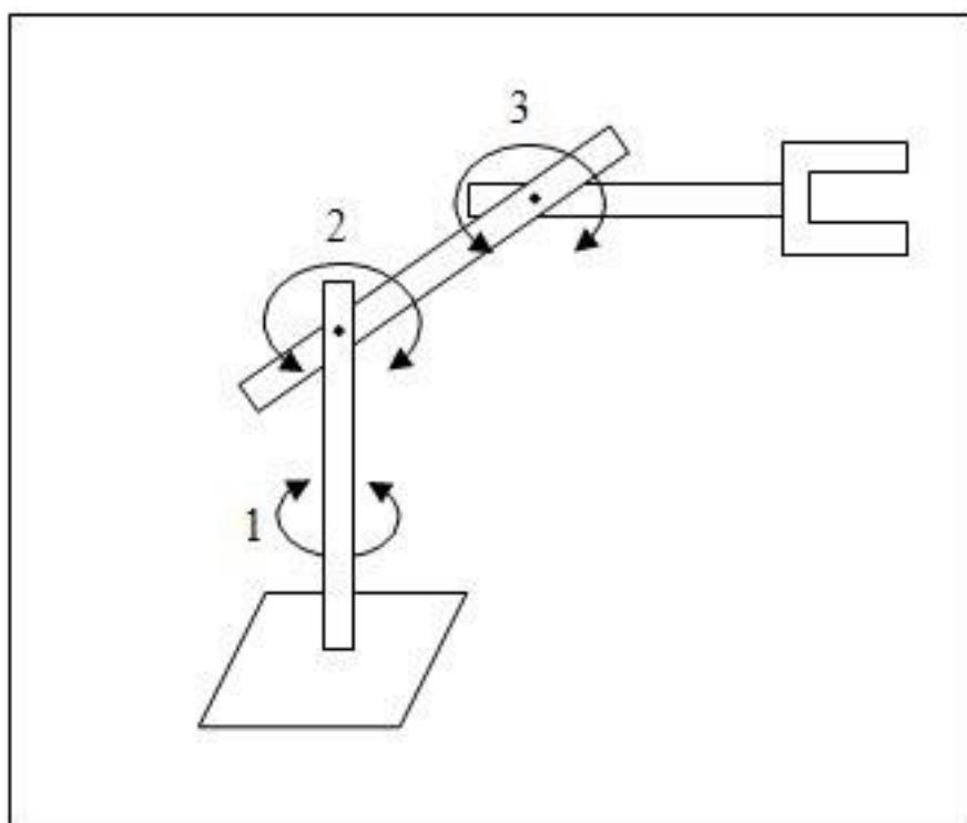
Slika 8. Primjer robota rotacijske konfiguracije
