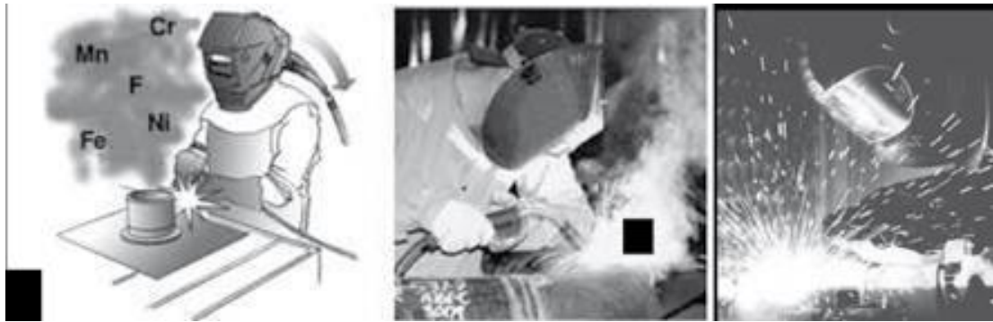
Slika 26. U procesu zavarivanja emitiraju se različiti elementi u parama koje štetno utječu na zdravlje radnika
