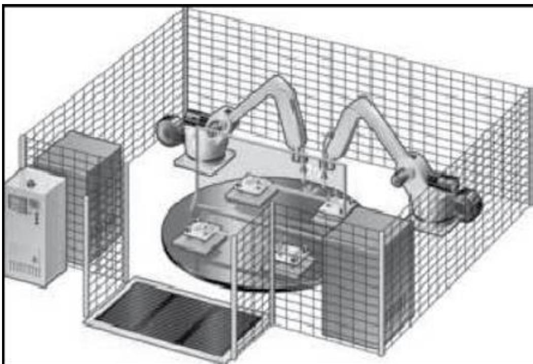
Slika 24. Zaštita radnog prostora industrijskog robota sa sigurnosnim podom
