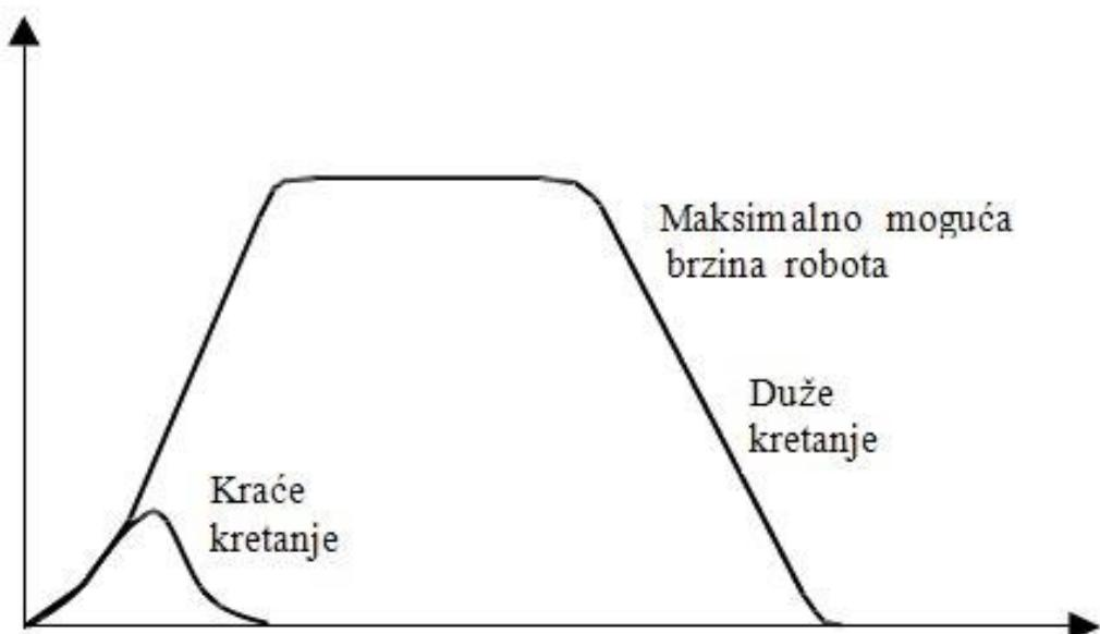
Slika 12. Odnos udaljenosti i brzine kretanja robota
