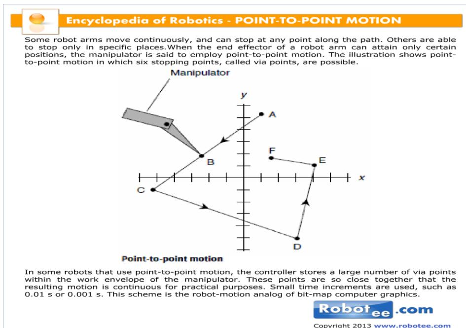
Slika 9. Prikaz kretanja robota od točke do točke
