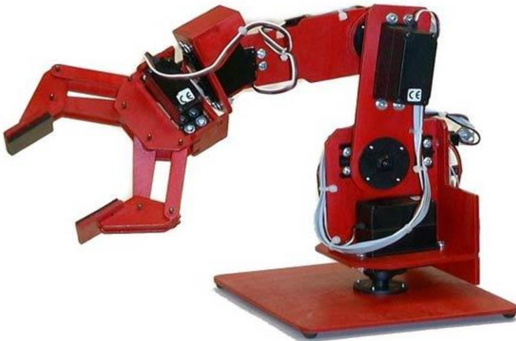
Slika 2. Industrijski robot (manipulator)
