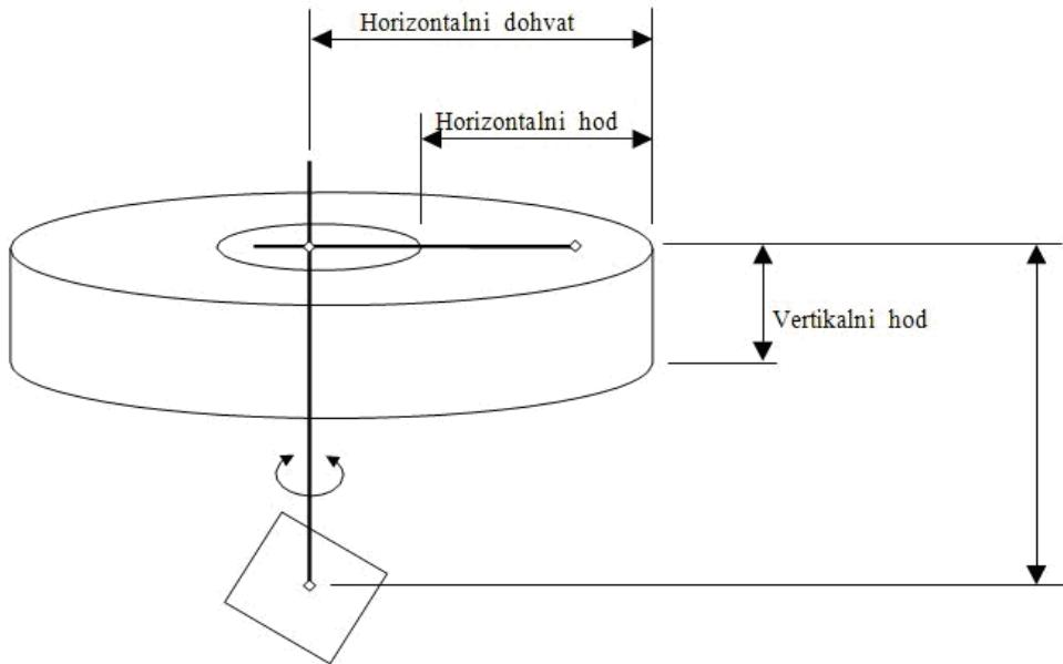
Slika 15. Dohvat i hod robota
