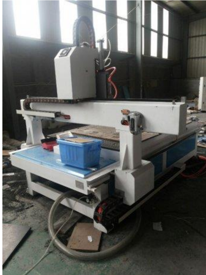
Slika 14: CNC stroj za izradu vrata i prozora
