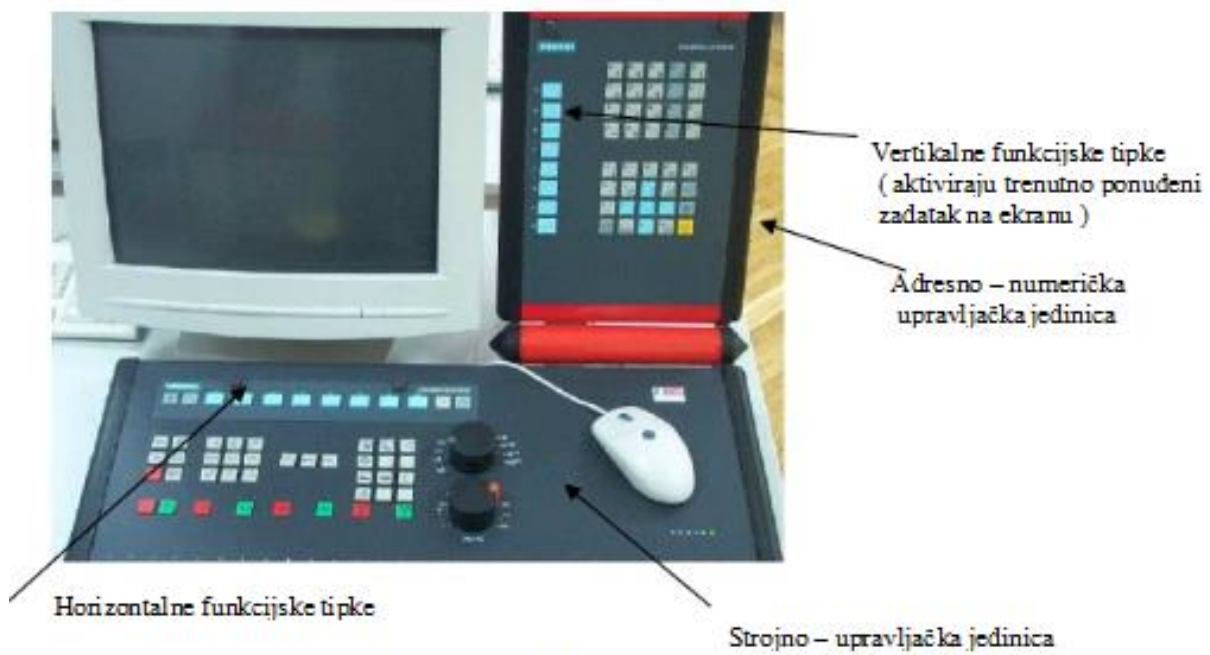
Slika 13: Upravljačka jedinica stroja
