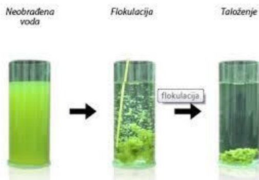
Slika 7. Flokulacija i taloženje otpadne vode
