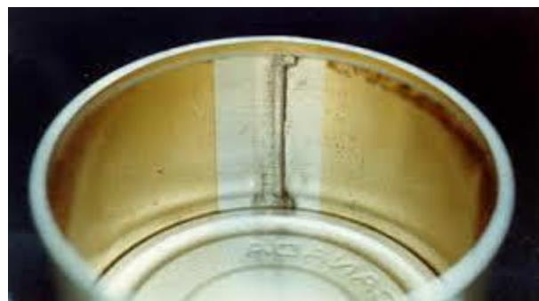
**Slika 2.** Korozija unutrašnje strane omotača limenke (<http://www.inspection.gc.ca>)
