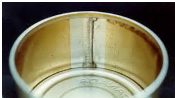
Slika 2. Korozija unutrašnje strane omotača limenke ( http://www.inspection.gc.ca )
