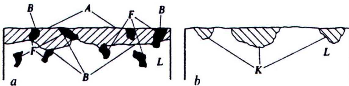
**Slika 5.** Selektivna korozija; *a* fazna, *b* komponentna (Esih i Dugi, 1997)
