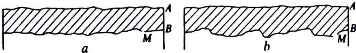
**Slika 3.** Opća korozija: *a* ravnomjena, *b* neravnomjerna (Esih i Dugi, 1997)
