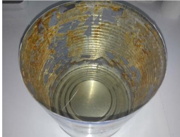
Slika 1. Korozija unutrašnjeg dijela limenke ( https://zir.nsk.hr/islandora/object/ptfos )
