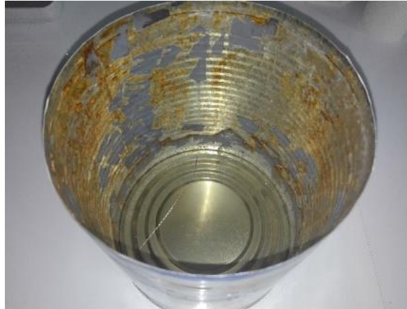
Slika 1. Korozija unutrašnjeg dijela limenke ( https://zir.nsk.hr/islandora/object/ptfos )
