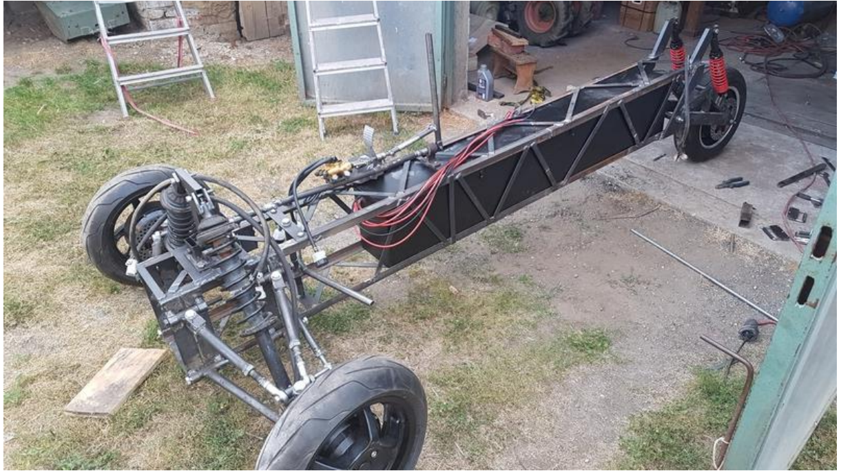
Slika 90.: Montirana baterija unutar konstrukcije
