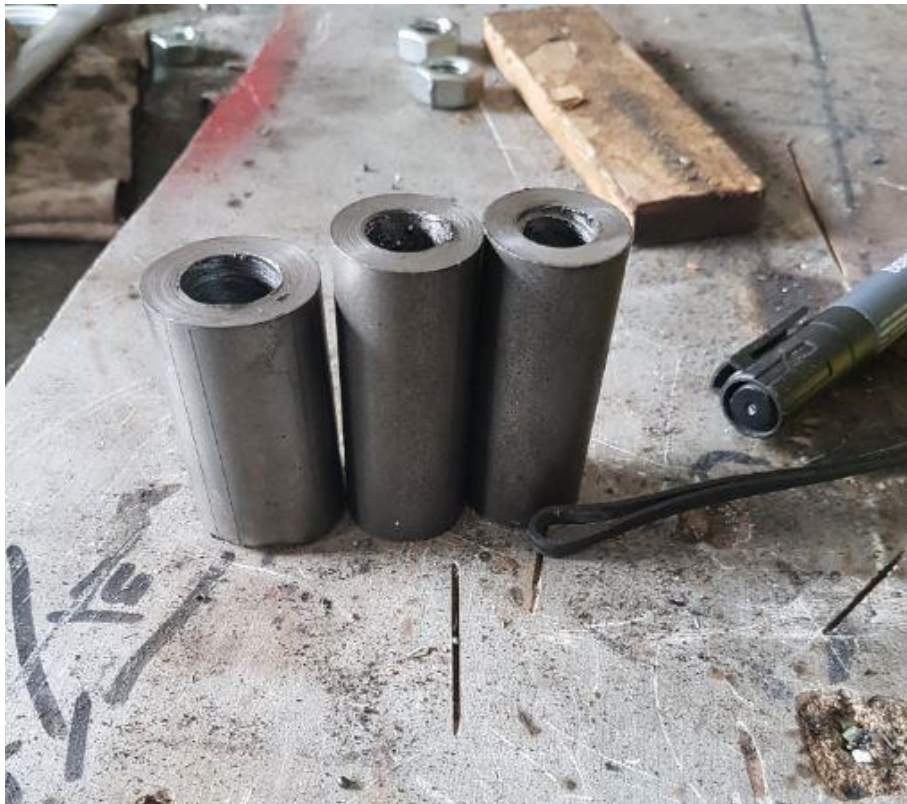
Slika 70.: Dijelom obrađeni nosači osovina
