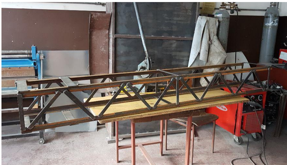
Slika 67.: Pregled zavarenih spojeva
