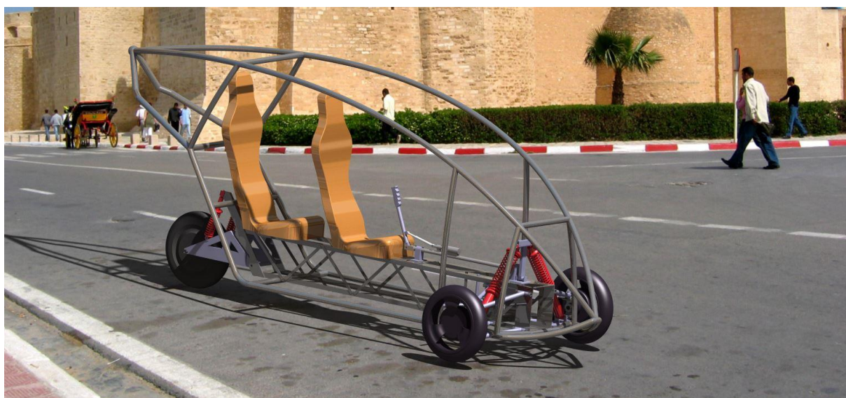
Slika 91.: Ilustrativni prikaz vozila bez oplata
