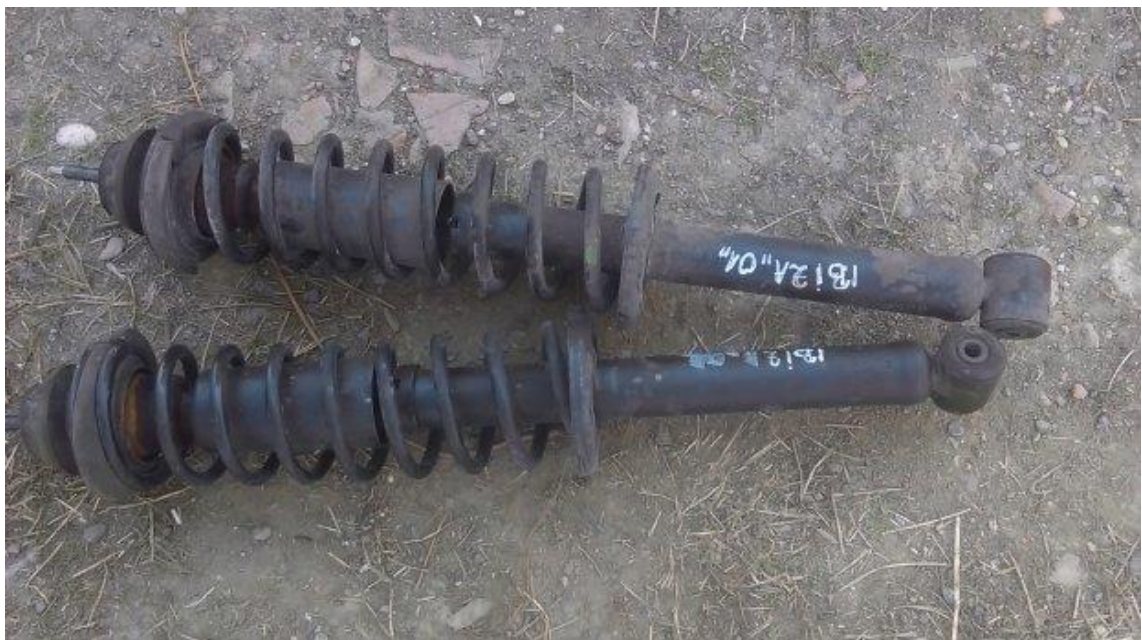
Slika 35.: Amortizeri za prednje kotače (Seat Ibiza, 2001.)
