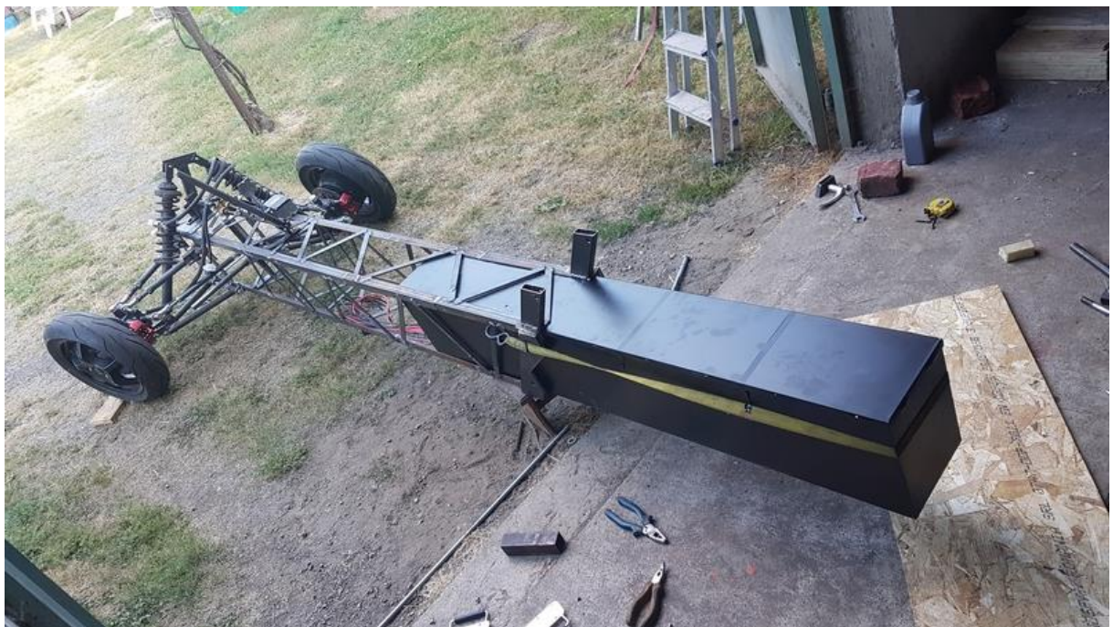
Slika 89.: Postupak uvlačenja baterije unutar konstrukcije
