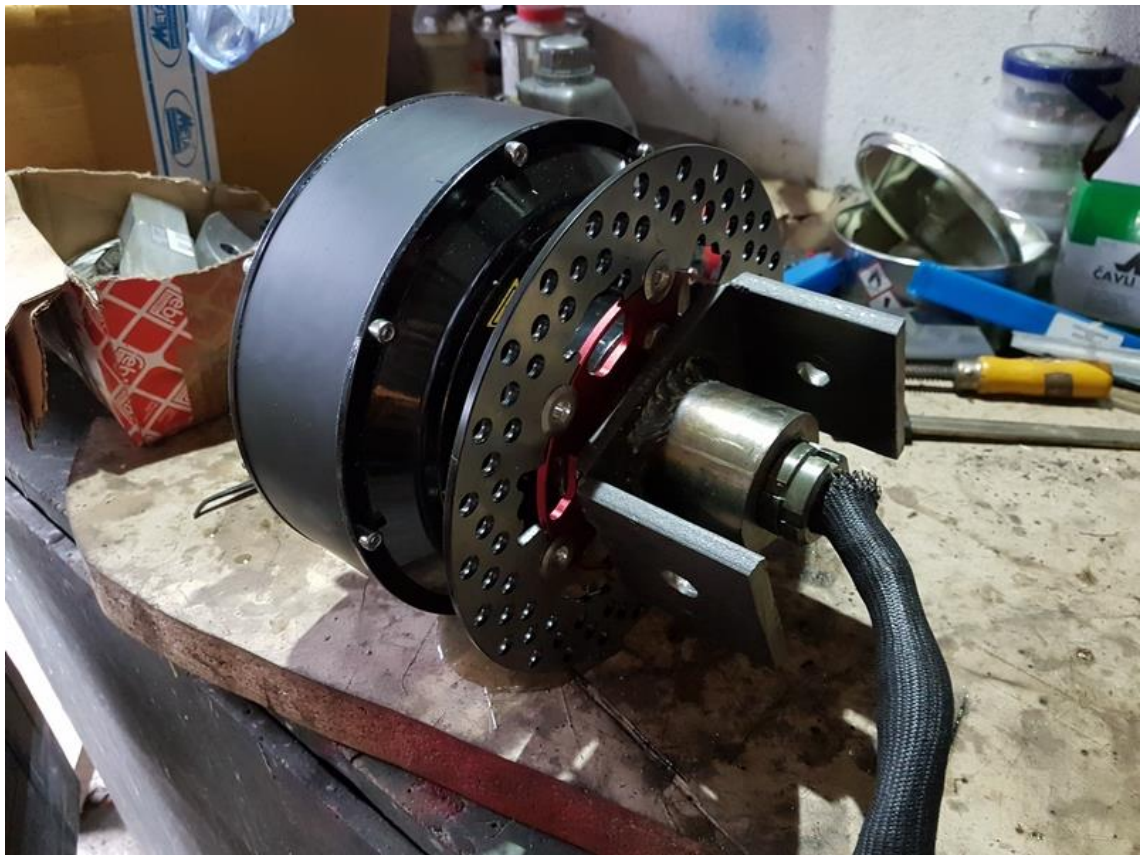
Slika 81.: Montaža prednjeg motora na C-nosač
