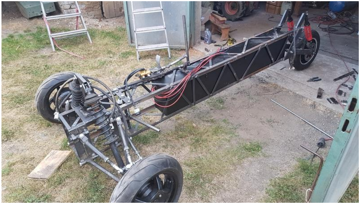
Slika 90.: Montirana baterija unutar konstrukcije
