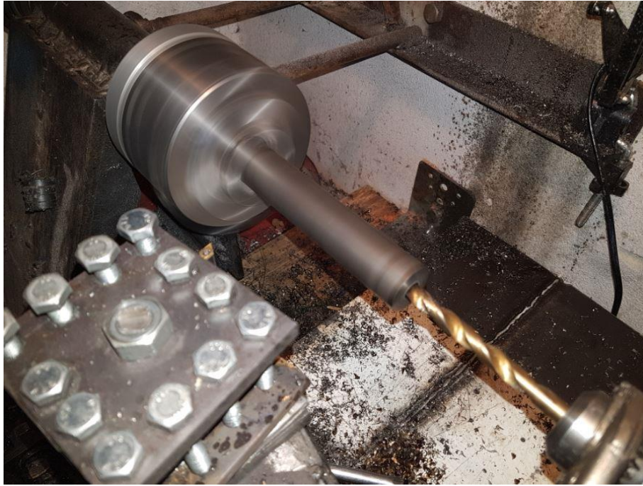
Slika 69.: Izrada nosača osovina na tokarskom stroju
