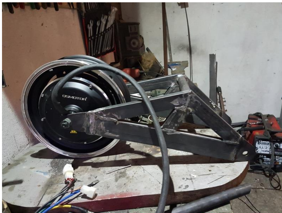
Slika 83.: montaža zadnjeg motora na zadnju vilicu ovjesa
