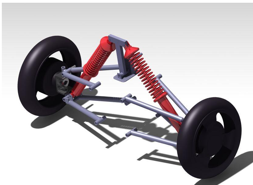
Slika 50.: Prikaz prednje suspenzije s ovjesom
