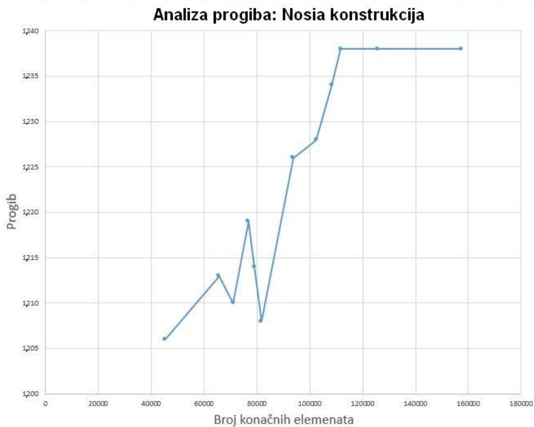
Dijagram 20.: FEM analiza progiba u zavisnosti o broju konačnih elemenata – nosiva konstrukcija
