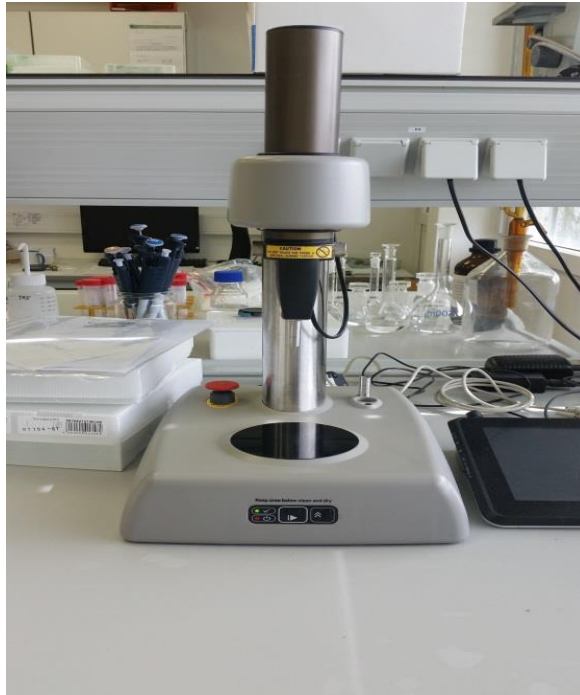
Slika 9. Analizator teksture voća i povrća (Autor slike: Lina Majhen)
