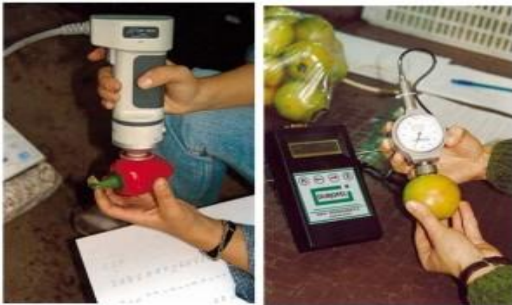
Slika 6. – Aparati za mjerenje zrelosti voća kolorimetrom i penetrometrom. Izvor; https://www.tehnologijahrane.com/enciklopedija/branje-i-priprema-voca-i-povrca-za-skladistenje , pristupljeno 01.02.2019.
