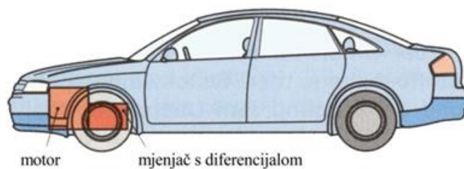
uzdužni motor ispred prednje osovine
