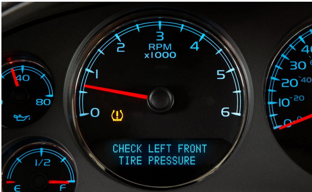
Slika 30. TPMS sustav na kontrolnoj ploči
