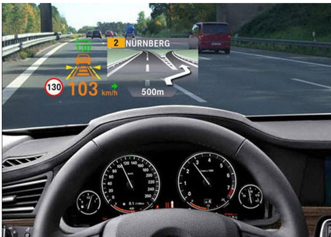
Slika 34. Prozirni ekran HUD sustava
