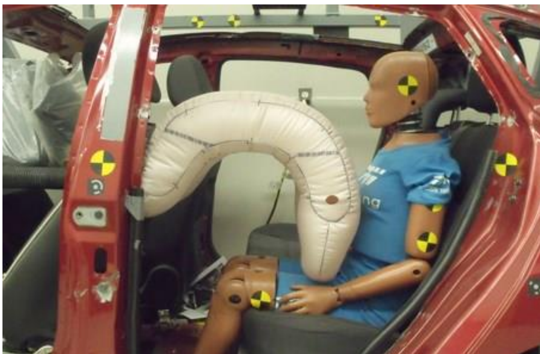
Slika 29. Prikaz djelovanja stražnjih zračnih jastuka
