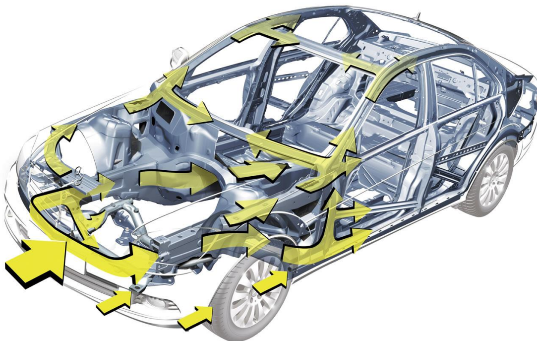
Slika 26. Deformacijske zone - preduvjet za crash-test
