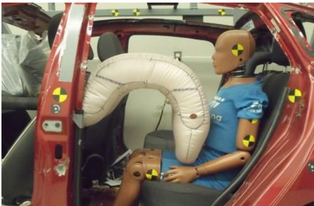
Slika 29. Prikaz djelovanja stražnjih zračnih jastuka
