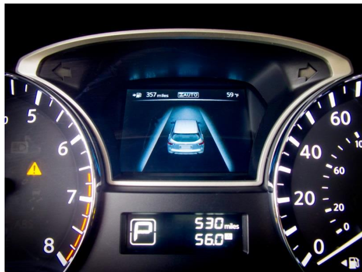
Slika 28. LDW sustav na kontrolnoj ploči
