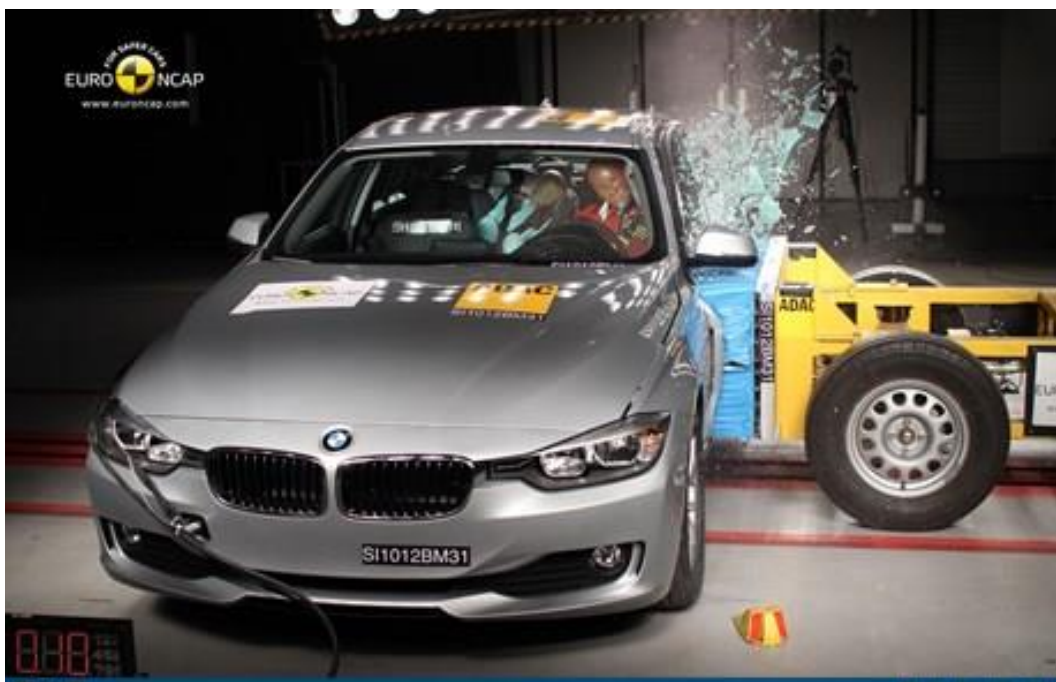
Slika 17. Testiranje na bočni udar
