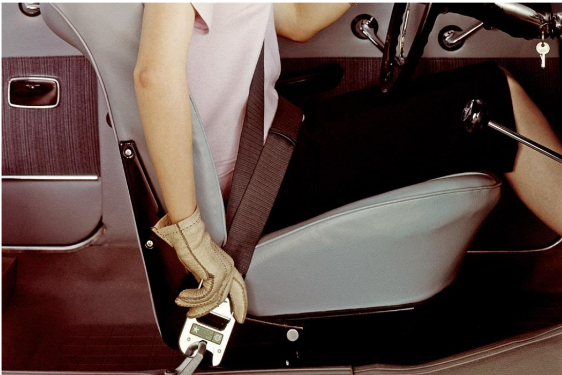
Slika 22. Pojas s pričvršćenjem u tri točke
