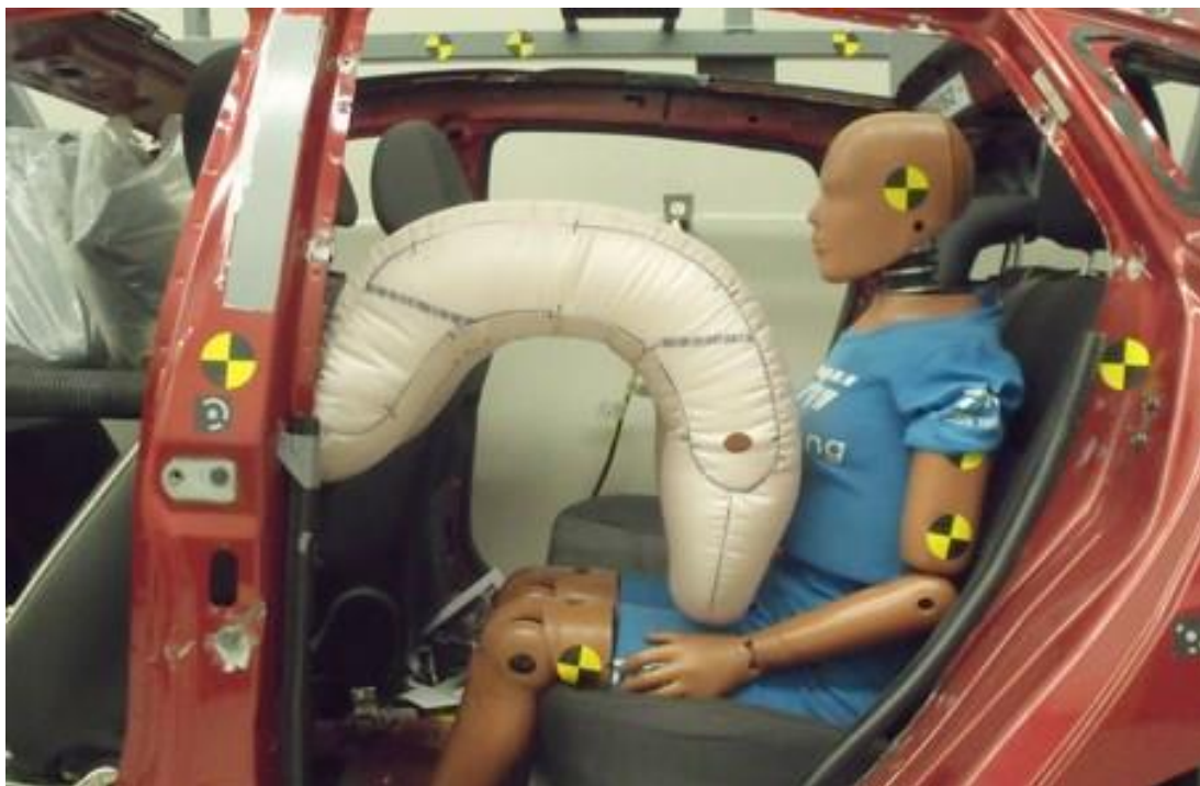
Slika 29. Prikaz djelovanja stražnjih zračnih jastuka
