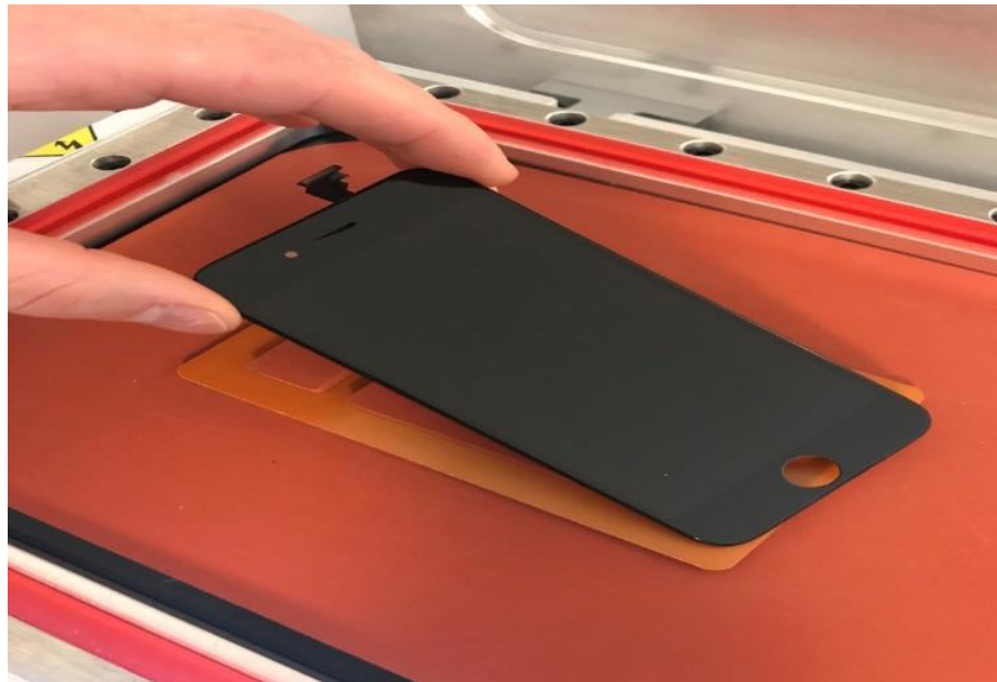
Slika 35. Predodžba LCD ekrana nakon laminiranja. Izvorno autor.
