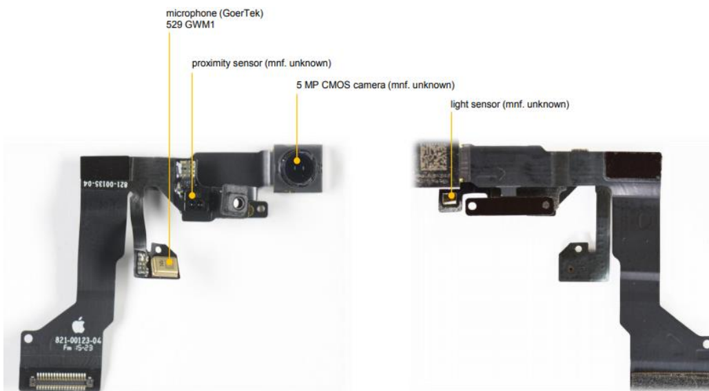
Slika 12. Predodžba flat s prednjom kamerom
