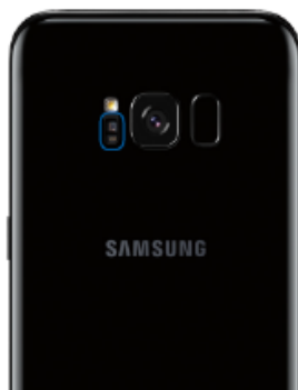
Slika 20. Predodžba pozicije senzora otkucaja srca
