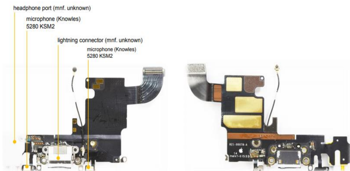
Slika 10. Predodžba flat konektora punjenja
