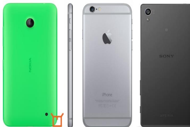
Slika 3. Predodžba polimernih, metalnih (aluminijska) i staklenih kućišta
