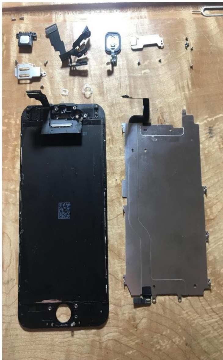
Slika 29. Predodžba rastavljenog ekrana. Izvorno autor.
