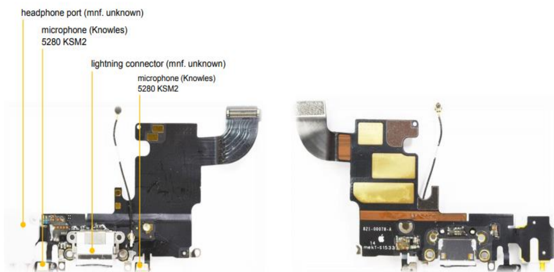
Slika 10. Predodžba flat konektora punjenja
