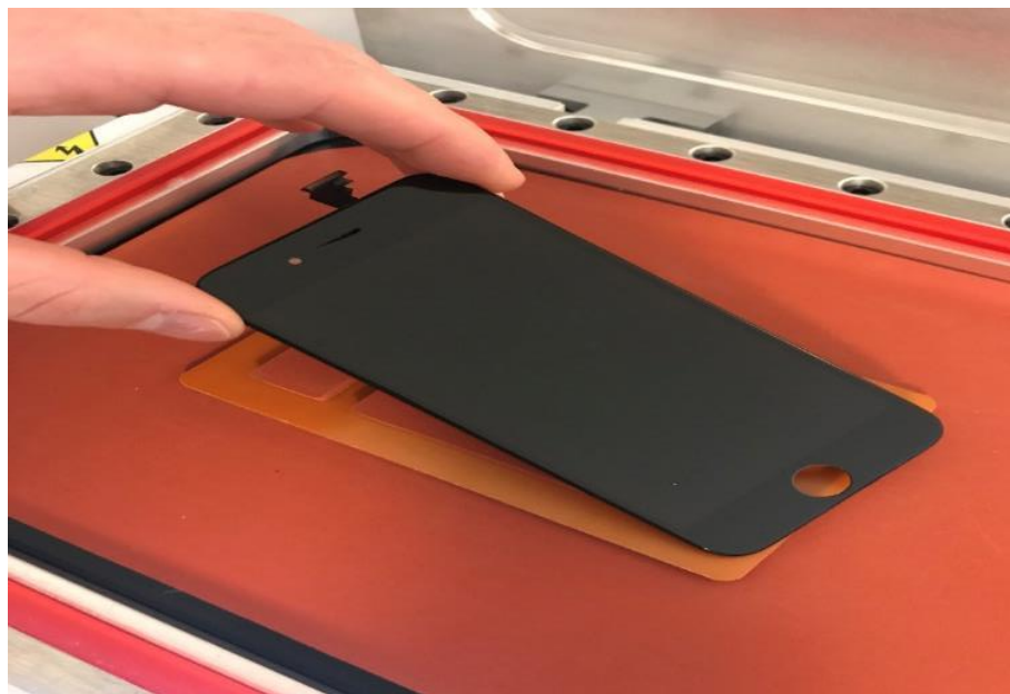
Slika 35. Predodžba LCD ekrana nakon laminiranja. Izvorno autor.
