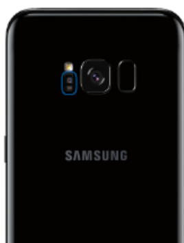
Slika 20. Predodžba pozicije senzora otkucaja srca
