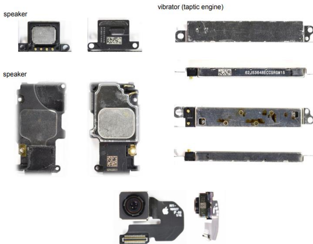
Slika 13. Predodžba zvučnika, prednje kamere, vibro motorića
