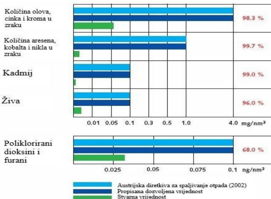
**Slika 20. Predodžba vrijednosti štetnih supstanca u zraku koji izlazi iz spalionice otpada. [27]**
