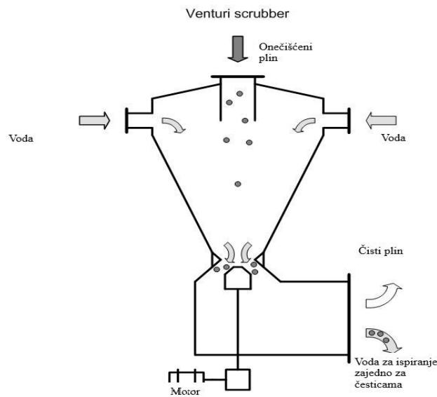
**Slika 17. Predodžba venturijevog ispirača plinova. [24]**
