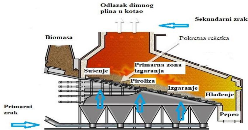
Slika 4. Predodžba rešetkaste peći za izgaranje otpada [9].
