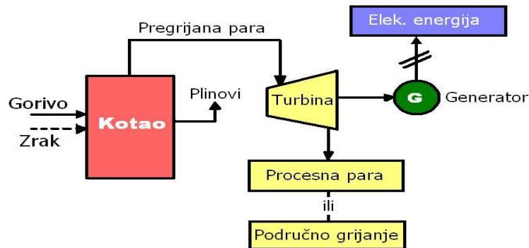
Slika 12. Predodžba tijeka pare u termodinamičkom kružnom procesu [16].
