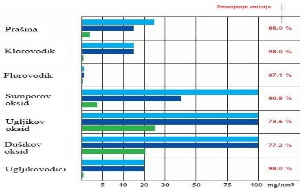
**Slika 19. Predodžba vrijednosti štetnih supstanca u zrak koji izlazi iz spalionice otpada. [27]**
