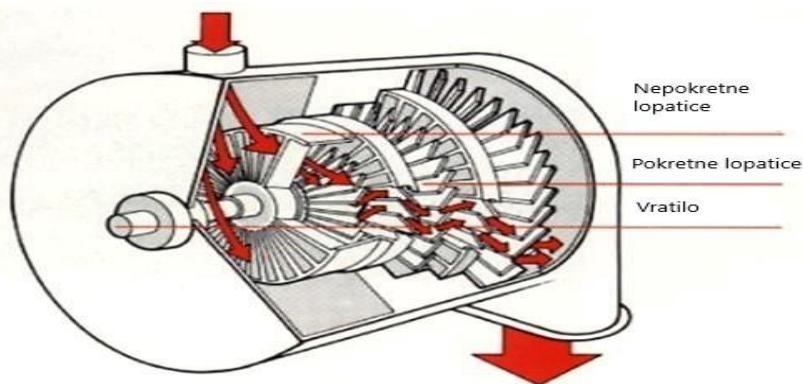
Slika 13. Predodžba tijeka pare u protočnom dijelu turbine [17].
